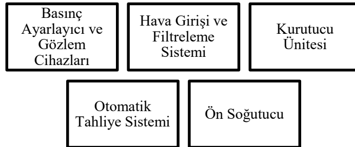
Şekil 16. Kontrol havası kurutucusu sisteminin temel bileşenleri
