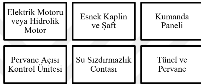
Şekil 11. Baş itici sisteminin temel bileşenleri
