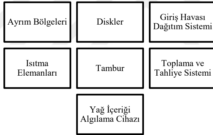
Şekil 6. Separatörün temel bileşenleri
