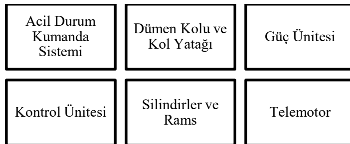
Şekil 13. Dümen makinelerinin temel bileşenleri
