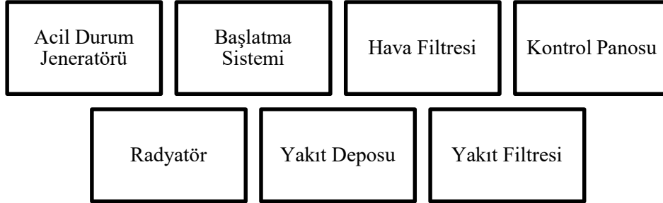
Şekil 15. Acil durum jeneratörü sisteminin temel bileşenleri
