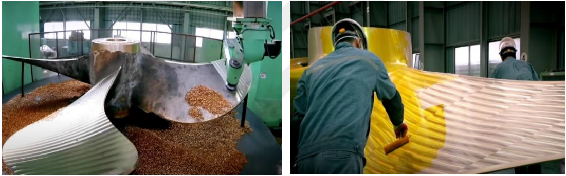
Şekil 2.29. Pervane imalatı son aşaması [48]
