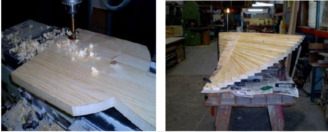
Şekil 2.28. Merkez deliği ve ahşap katman yığını [44]
