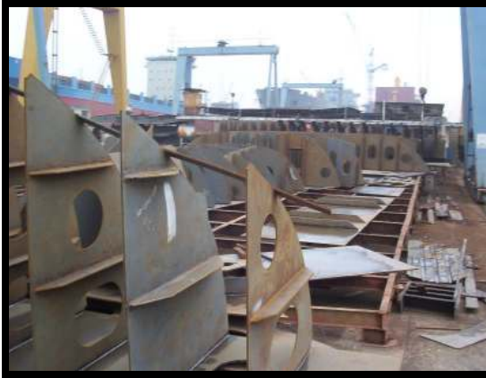
Resim-5.9 Tersanede ön imalat ve parçaların blok için düzenlenmesi ( solda) Resim -5.10 Tuzla özel sektör tersaneler bölgesi genel görünüş-2008 (sağda) (Kaynak: Yazar)
