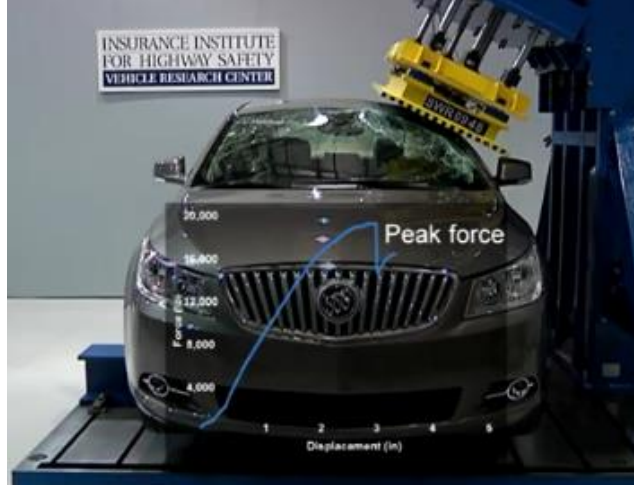
Şekil 2.3 Otomobilin tavan darbe testi (iihs.org, 2021)
