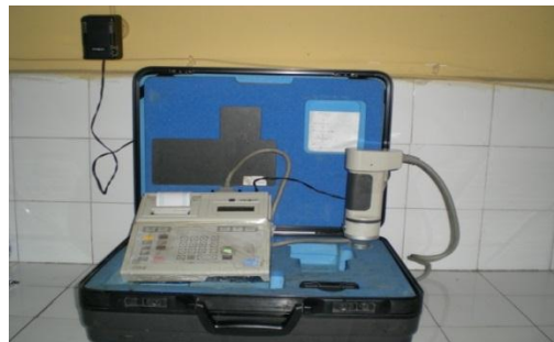
Şekil 3.6. CR-300 model chromameter, Minolta (Japonya) renk tayin cihazı (Ş.Irmak)
