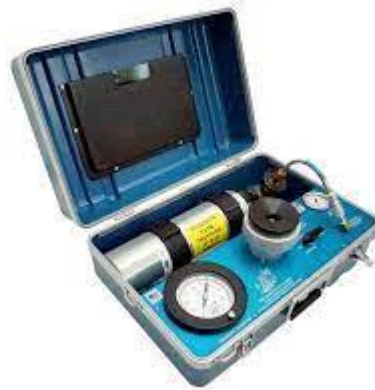
Şekil 3.2. Yaprak su potansiyelini belirlemede kullanılan cihaz
