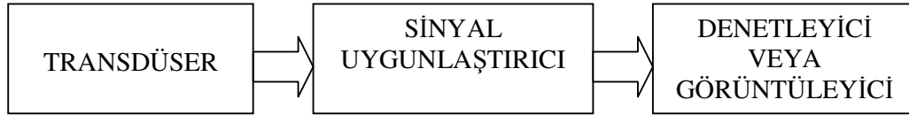
Şekil 2.1. Ölçme ve kontrol sisteminin blok diyagramı [6].
