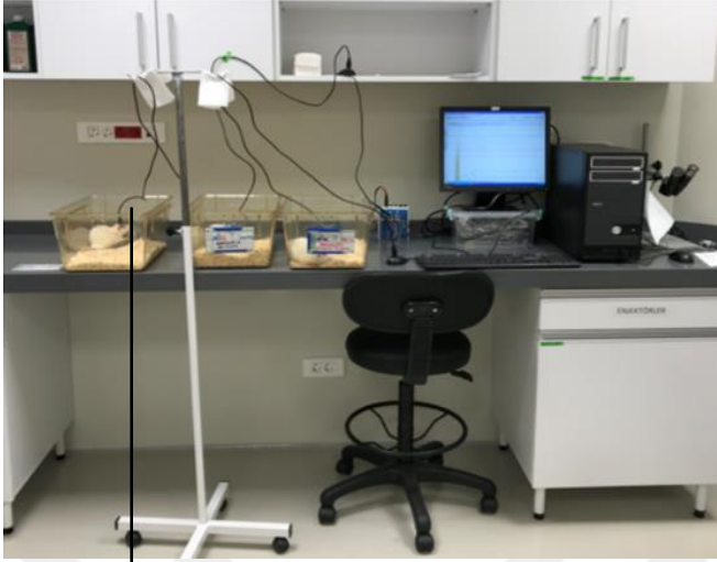
Şekil 3-2: EEG kayıtlarının alındığı sistem (System plus Micromed, Italy).
