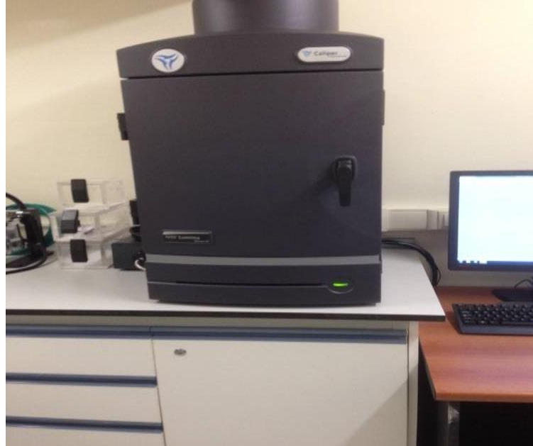
Şekil 3-4: Görüntülemede kullanılan IVIS ( Invivo Imaging System Caliper Lumina III) cihazı
