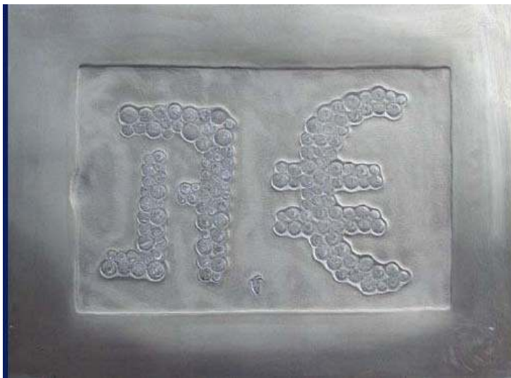
Resim 4.6. Alüminyum plaka üzerine madeni paraların patlayıcı yardımı ile engrave edilmesi
