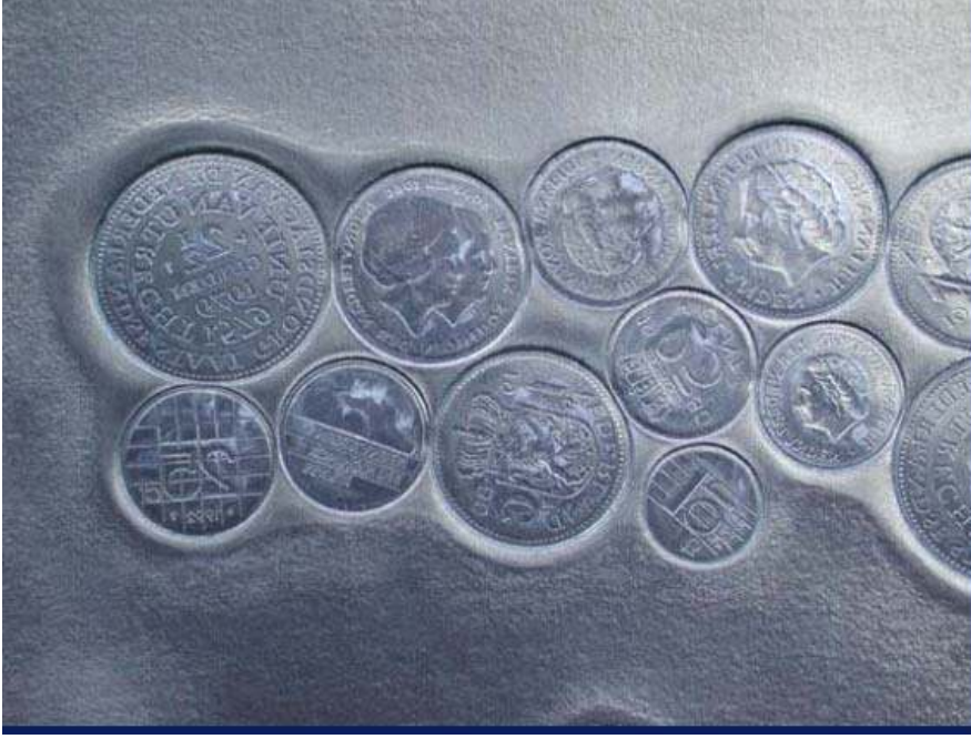
Resim 4.7. Alüminyum plaka üzerine madeni paraların patlayıcı yardımı ile engrave edilmesi
