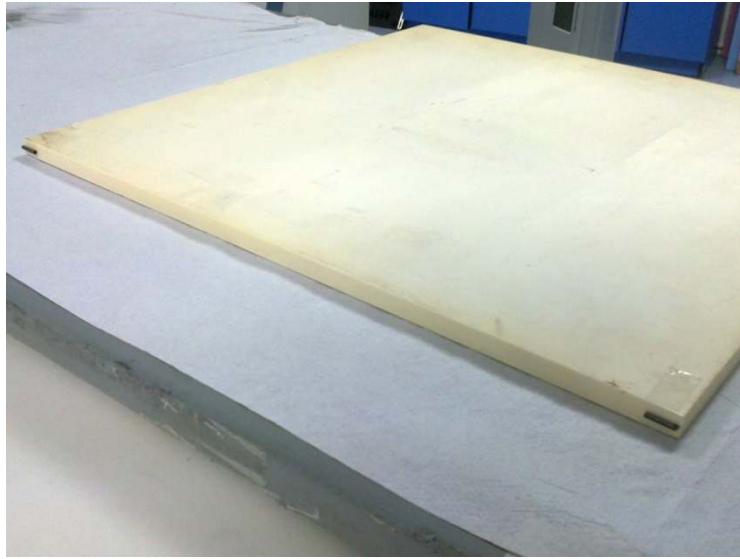
Şekil 19: İnce metal parçaların pleksiglass plakanın uçlarına sabitlenişi
