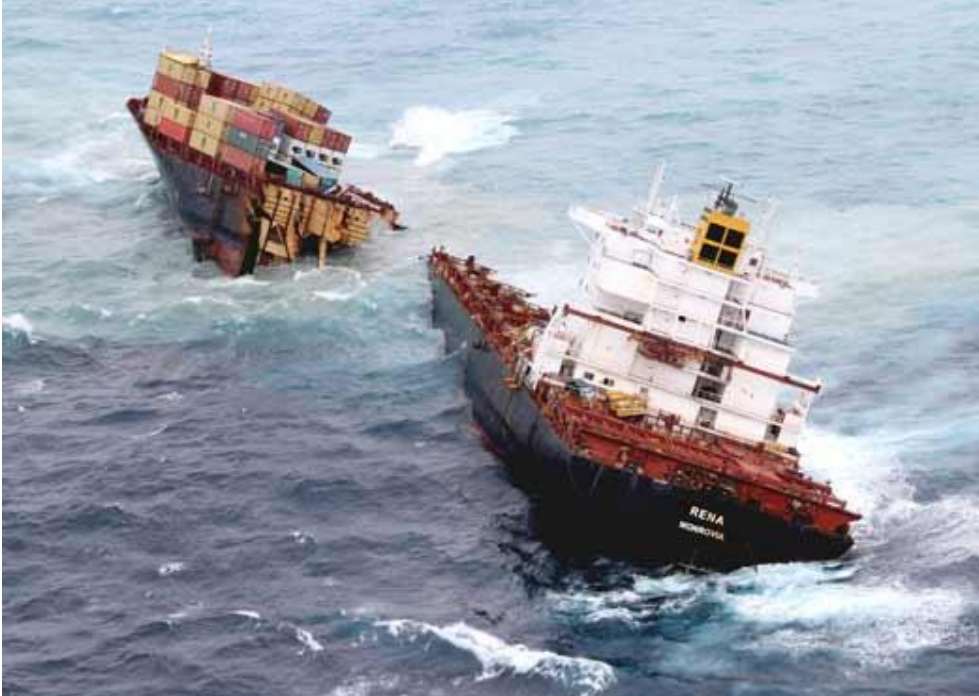
Şekil 2.2: Maruz kaldığı yükler sebebiyle gövdesinden kırılmış bir konteyner gemisi.
