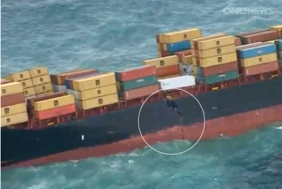
Şekil 1.3: Seyir esnasında gövdesinden kırılmış bir konteyner gemisi.
