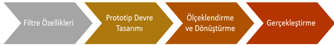
Şekil 2.13. Filtre Tasarım Aşamaları
