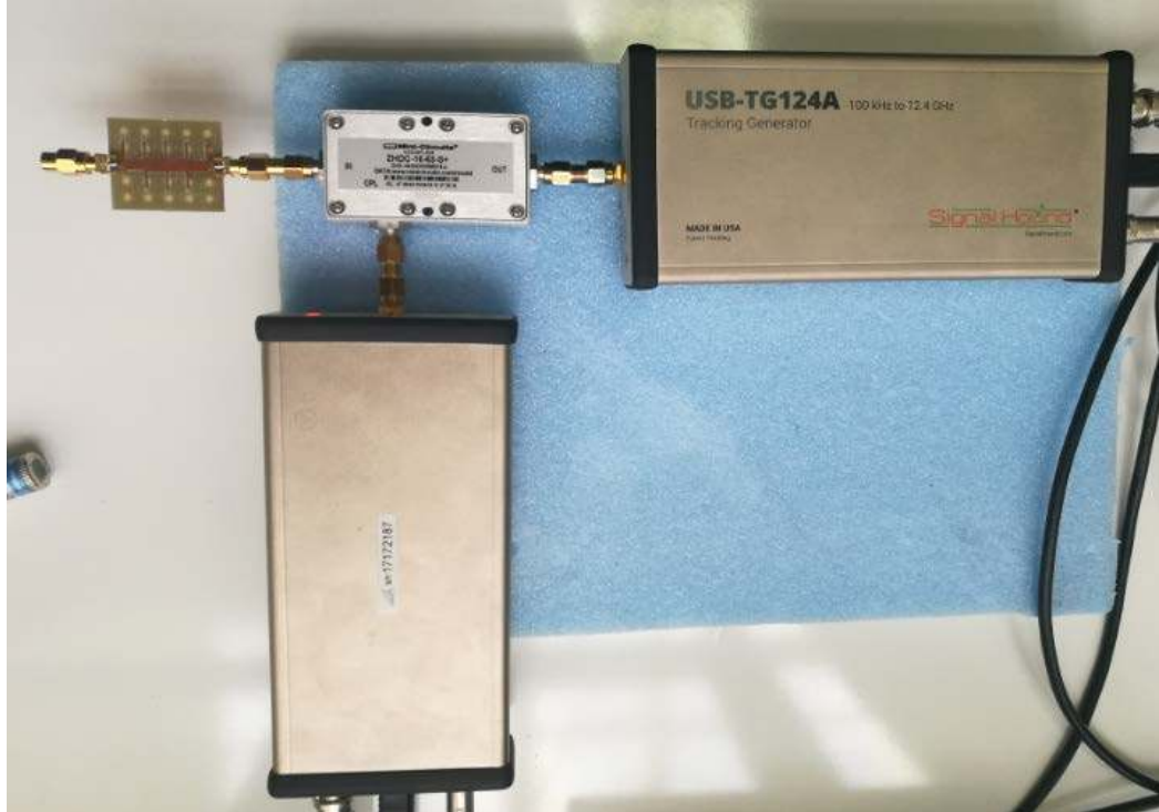
Şekil 4.16. S11 Değerleri Filtre Ölçümü
