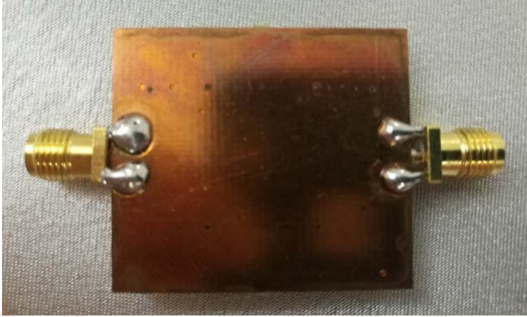
Şekil 4.19. Mikroşerit BGF Taban İletkeni Kusuruz Yapıdaki Filtrenin Alt Yüzeyindeki Tasarım
