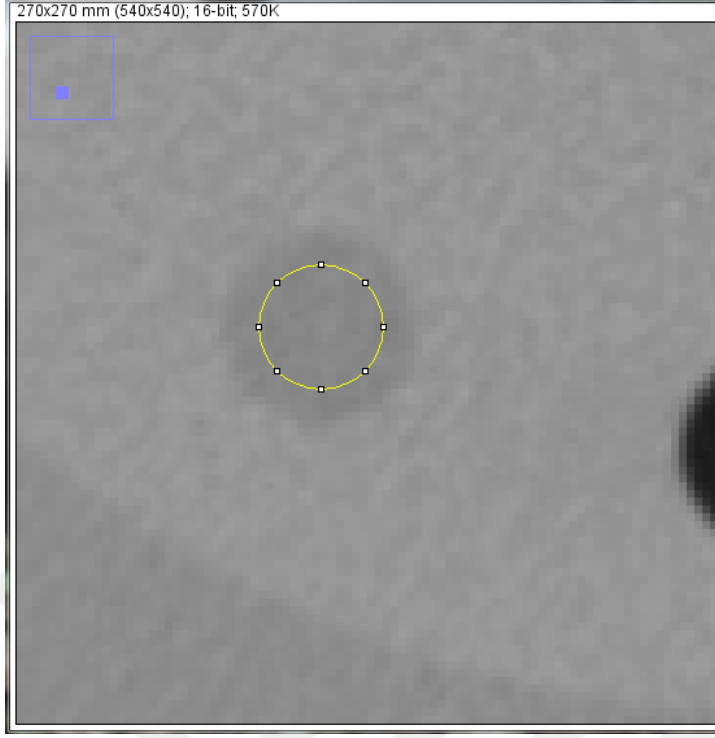
Şekil 4.10 Catphan 503 fantomu, düzgünlük modülü, Polystyrene bölgesi seçimi görüntüsü
