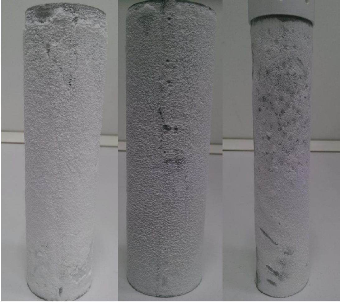
Şekil 5.19: Farklı debilerle hazırlanan kaplamalar (Soldan deney numara sırası: 10, 13, 14).
