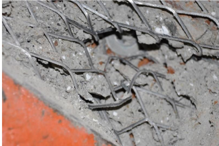
Şekil 4.6. MBW 2,0-200 deney sonu hasar durumu
