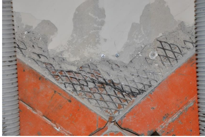
Şekil 4.16. MBW 3,0-200 deney sonu hasar durumu
