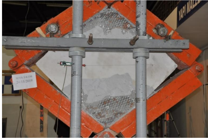
Şekil 5.3. MBW 3,0-150 deney elemanlarının deney sonu hasar durumu
