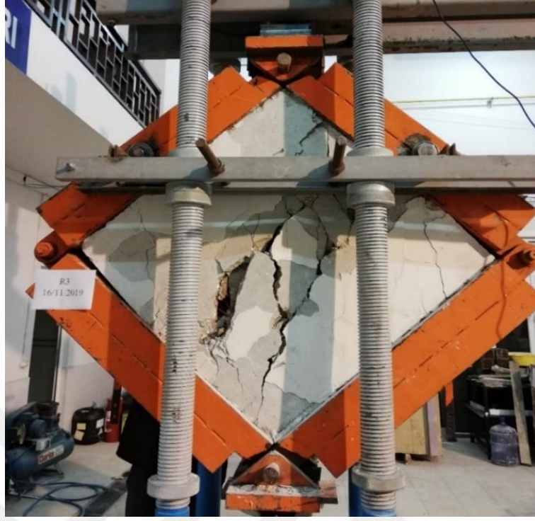
Şekil 4.2. R (Referans deney elemanın) deney sonrası durumu
