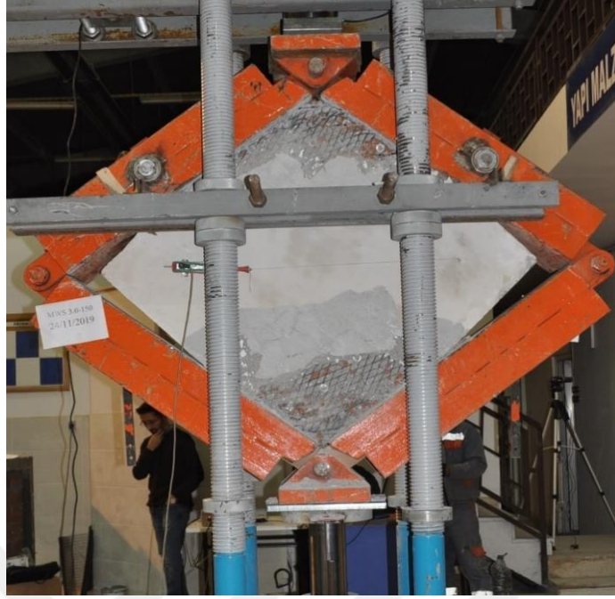
Şekil 4.12. MBW3,0-150 elemanının deney sırası hasar durumu
