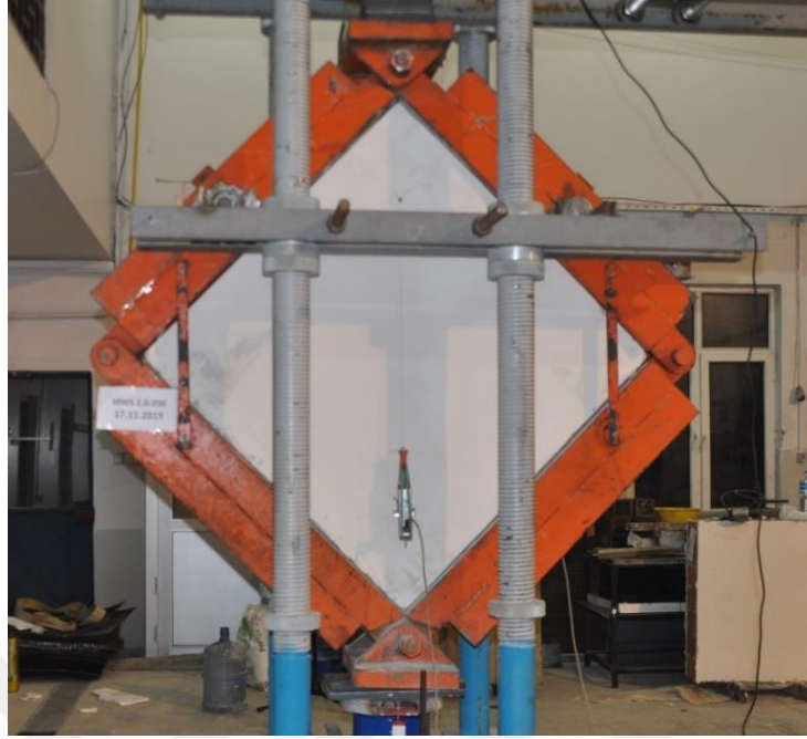
Şekil 4.15. MBW 3,0-200 deney öncesi durum
