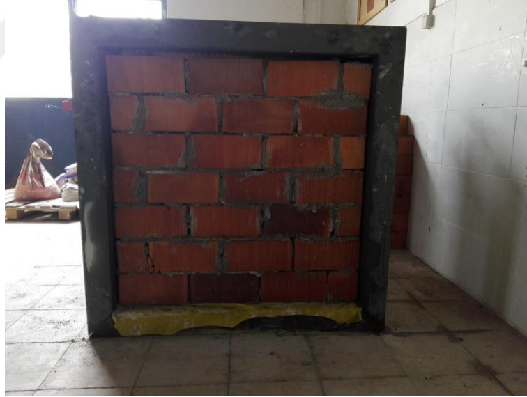
Şekil 3.20. Çerçeve içinde bitmiş tuğla duvar durumu
