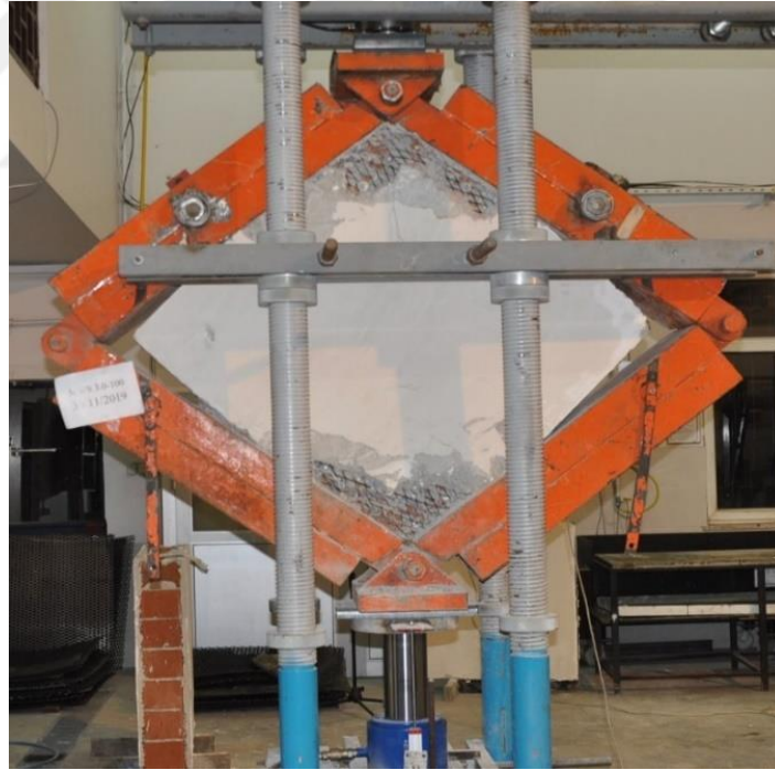
Şekil 4.9. MBW 3,0-100 elemanının deney sonu hasar durumu
