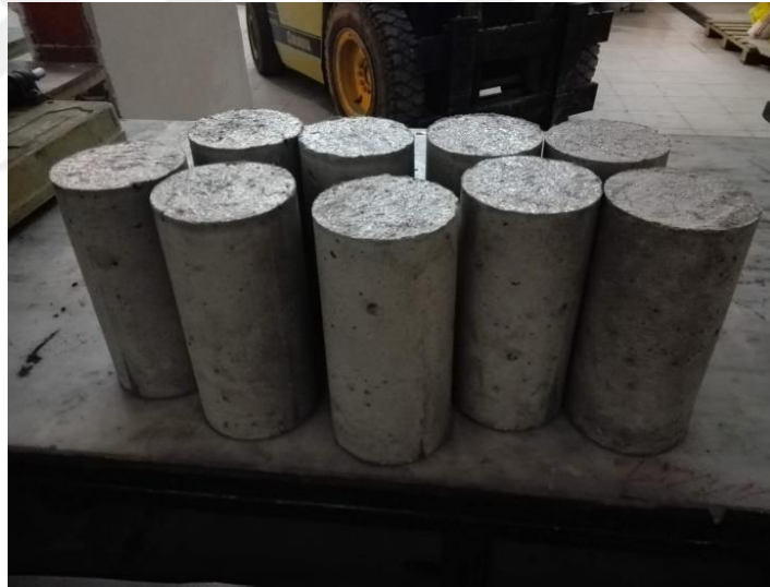
Şekil 3.10. Harç numunelerin kalıptan çıkarılmış durumu
