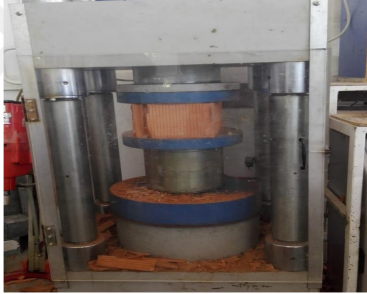
Şekil 3.3. Düşey blok tuğla duvar basınç deneyi
