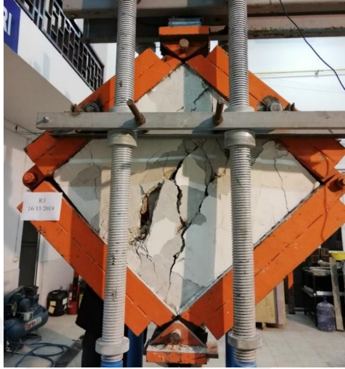
Şekil 5.1. R (Referans eleman) deney elemanın deney sonu hasar durumu
