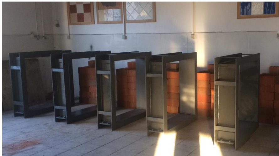
Şekil 4.17. Deney elemanları için hazırlanan çelik çerçeveler
