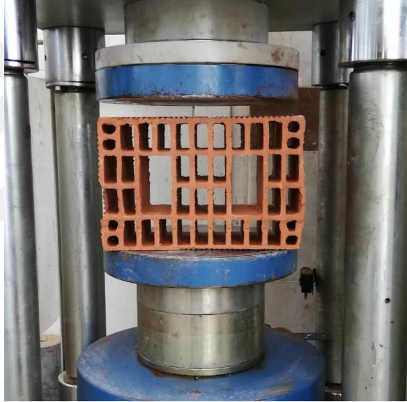
Şekil 4.2. Düşey delikli tuğlanın basınç makinesiyle kırılması
