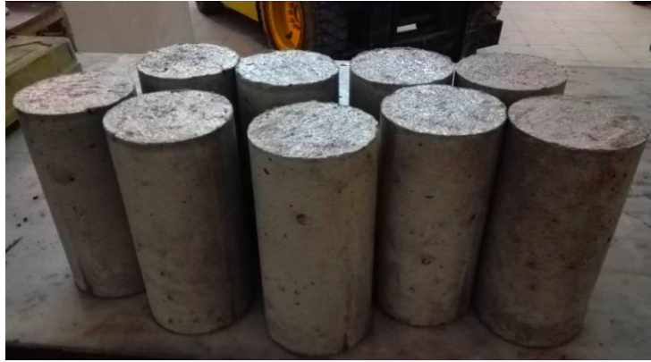
Şekil 4.8. Harç numunelerin kalıptan çıkarılmış durumu
