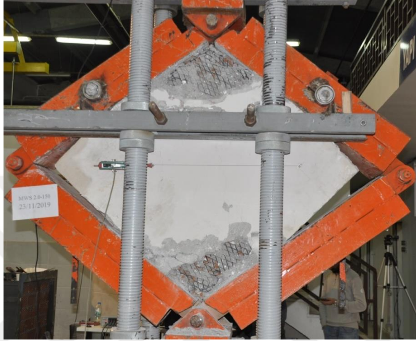
Şekil 5.11. MBW 2,0-150 deney elemanının deneyden sonra hasar durumu
