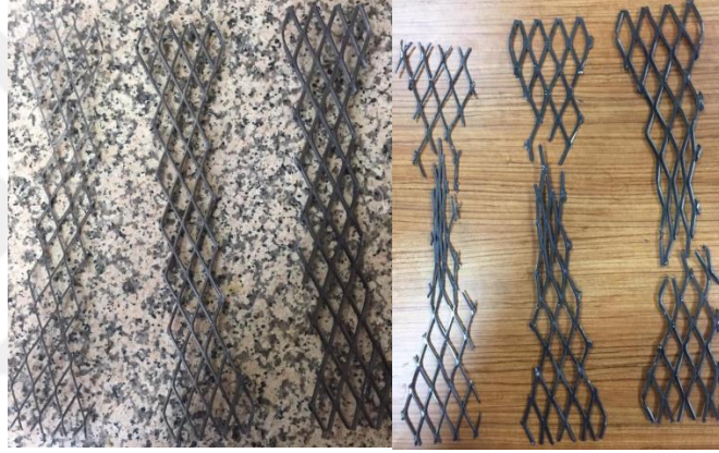
Şekil 4.5. Çelik levhaların deneyden önce ve sonraki durumu
