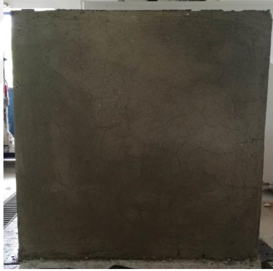
Şekil 4.22. Deney elemanlarının sıvanması
