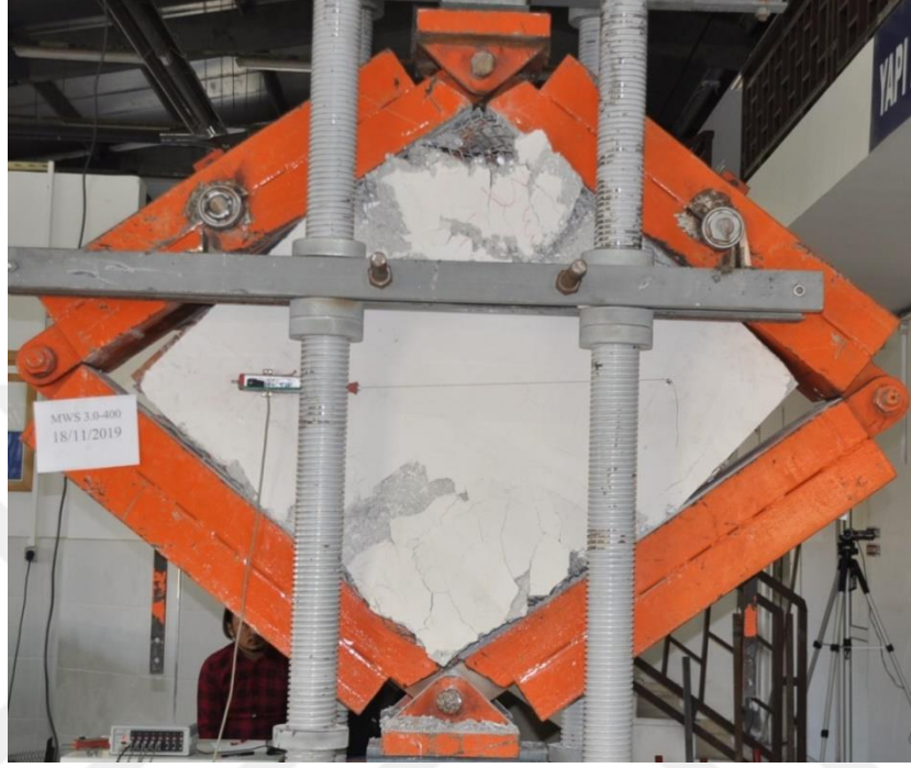
Şekil 5.5. MBW 3.0-400 deneme elemanının deneyden sonra hasar durumu
