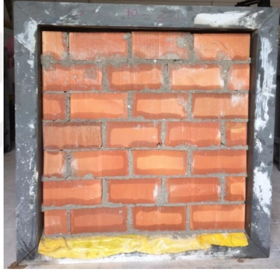
Şekil 4.19. Çerçeve içinde bitmiş tuğla duvar durumu
