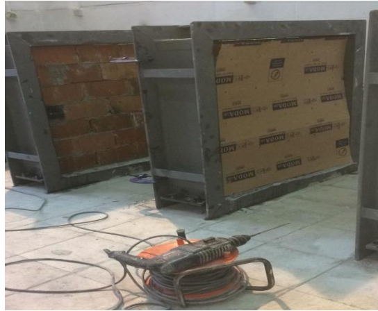
Şekil 4.20. Deney elemanlarının yapım aşamasında bulon deliklerinin açılması
