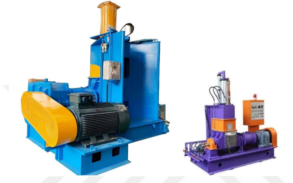
Şekil 4.1. NBR/EG kauçuk kompozitlerinin hazırlanmasında kullanılan üretim tipi ve laboratuvar tipi kapalı karıştırıcı (kneader) makineleri
