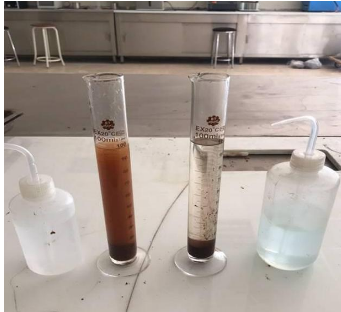
Şekil 3.13. Serbest şişme indeksi deneyi
