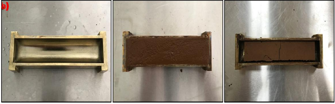
Şekil 3.16. Büzülme deneyi; Büzülme kalıbı (a), Yaş numune (b), Etüvde kurutulmuş numune (c)
