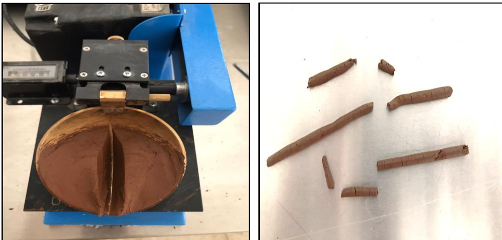
řekil 3.12. Atterberg limitleri; (a) Likit limit; (b) Plastik limit
