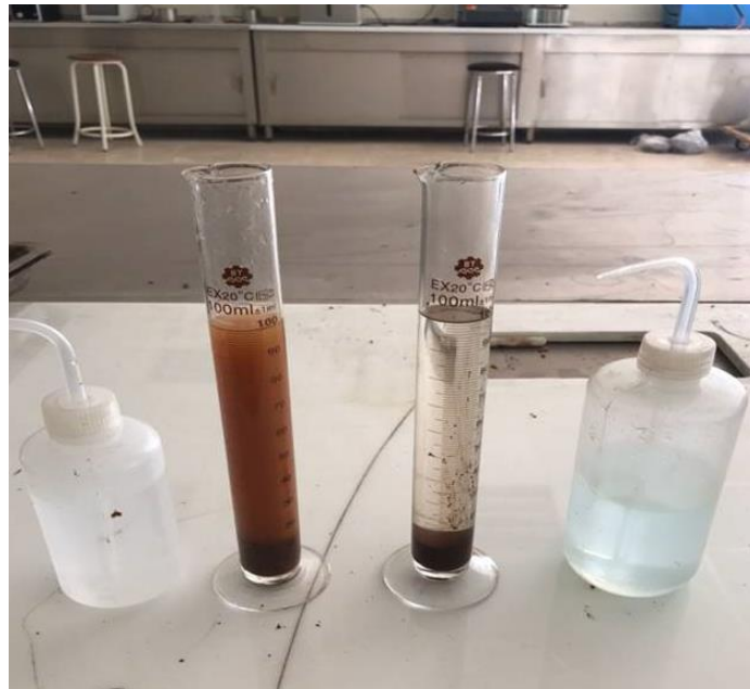
Şekil 3.13. Serbest şişme indeksi deneyi
