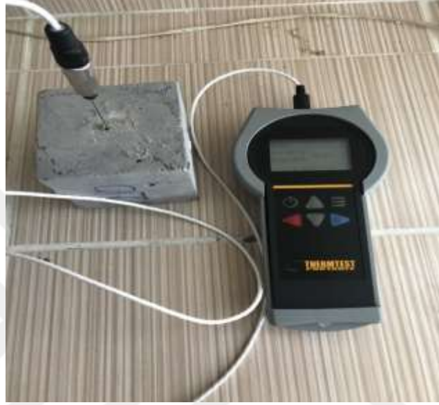
Şekil 5.15. Isı iletim katsayısı ölçümü alınan beton numune
