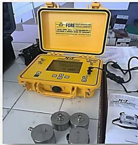
Şekil 5.13. Ultrasonik test cihazının görünümü ve şematik diyagramı
