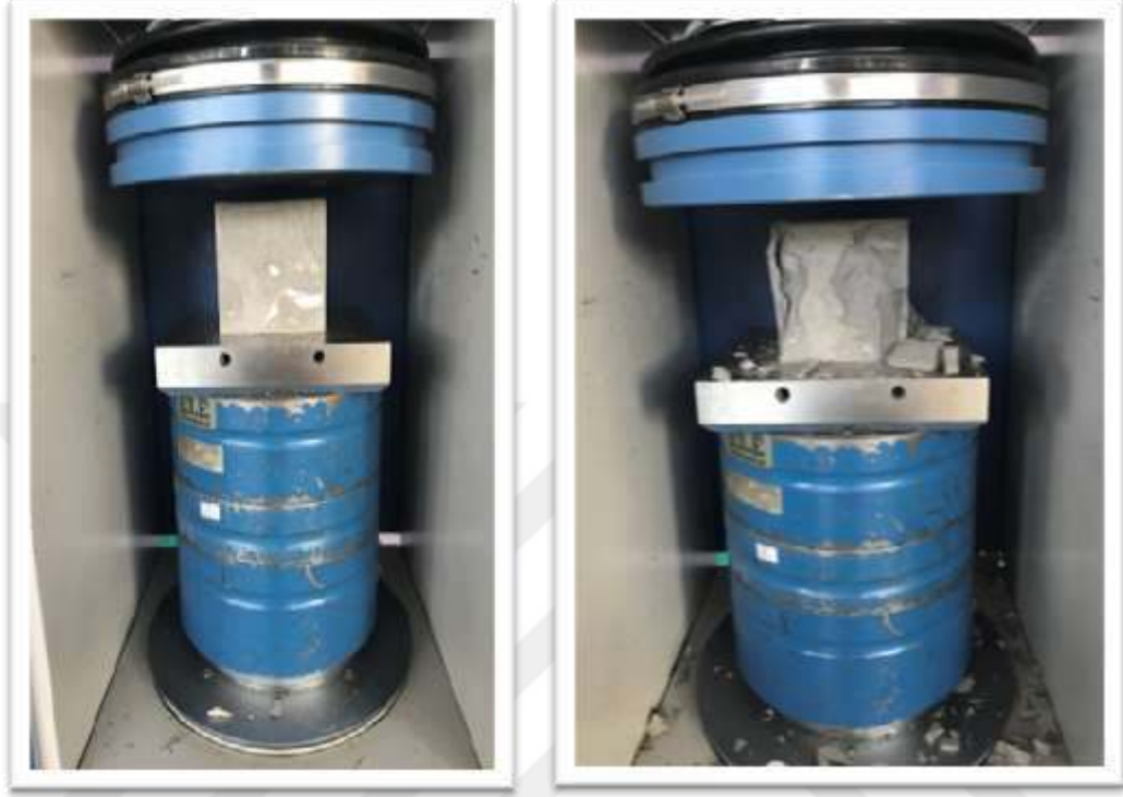
Şekil 5.7. Basınç ve çekme dayanımı deney numunesinin görüntüsü
