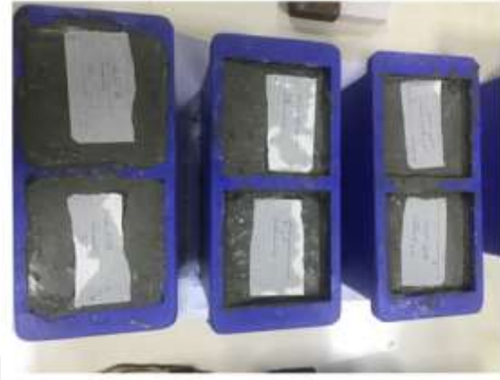
Şekil 5.4. Kalıplara dökülen harç numuneleri
