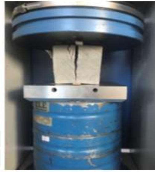
Şekil 5.8. Yarmada çekme dayanımı deney düzeneği
