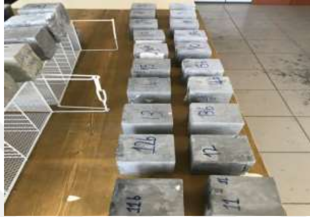
Şekil 5.11. Kurumaya bırakılan beton numuneler
