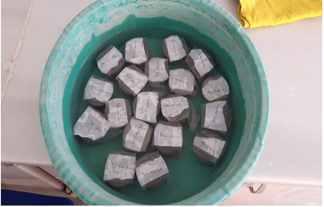
Şekil 3.13. Geçirimlilik deney numunelerinin suya doymun hale getirilmesi
