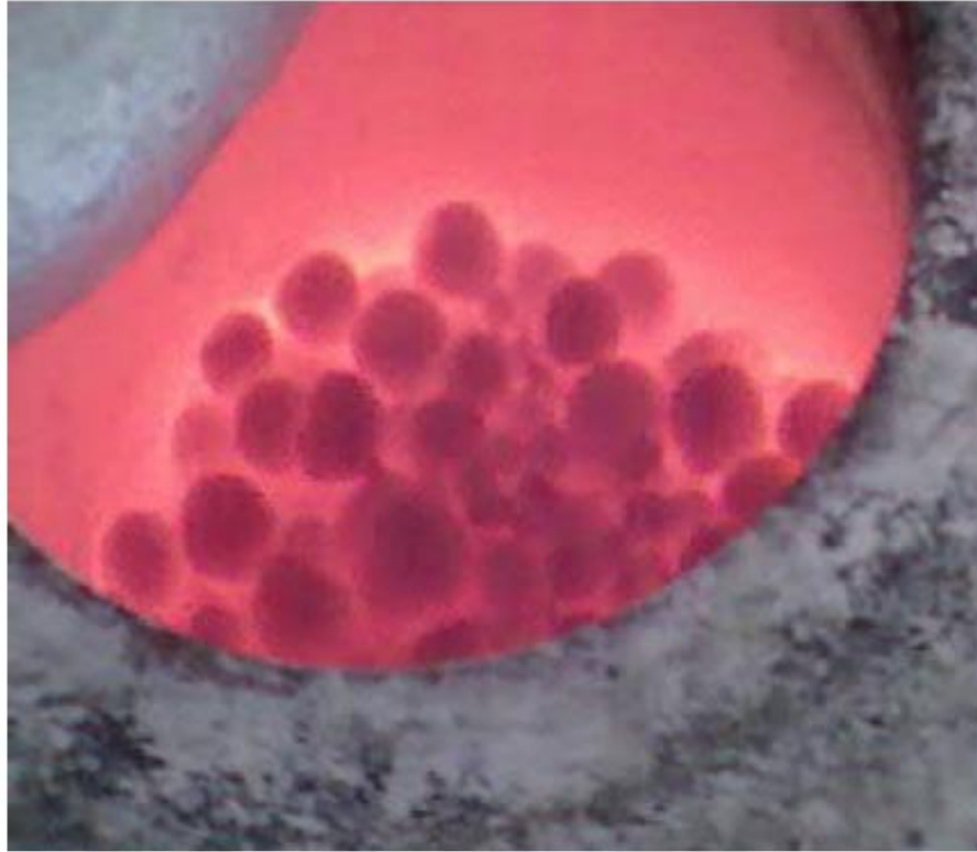
Şekil 2.8. Kür havuzu fırını (max. sıcaklık 1100°C) görünümü (Şimşek ve Gökçe, 2017)
