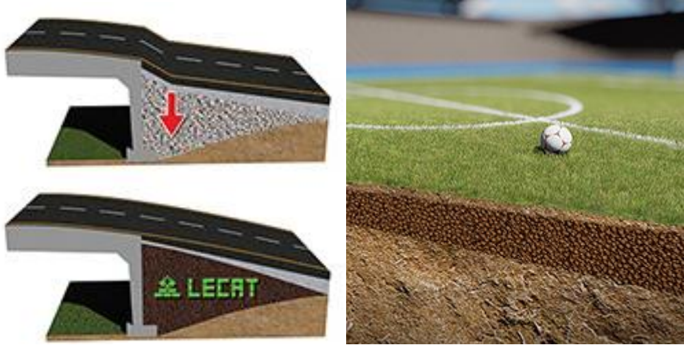
Şekil 2.6. GKA'nın dolgu malzemesi olarak kullanımı
