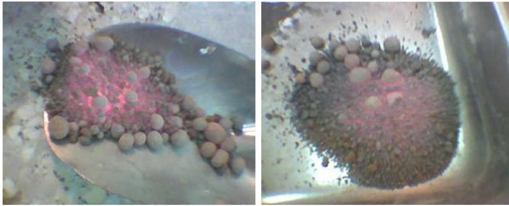
Şekil 2.9. Genleşmiş kil agregalarının 1100°C de 10 dakika pişirilmesinden sonraki görünümü
