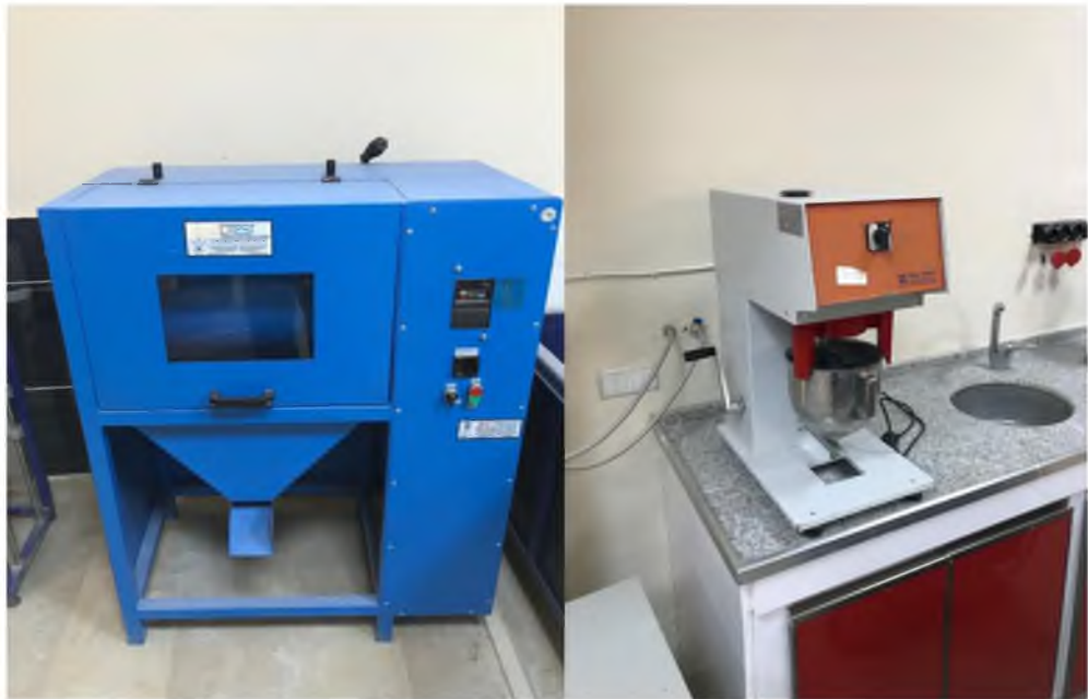
Resim 3.5. Malzemeleri harmanladığımız değirmen ve karışım hazırlama kabı
