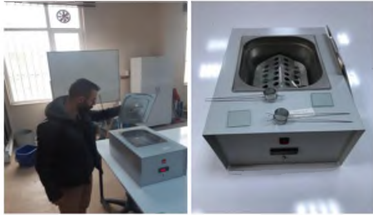
Resim 3.11. Le Chatelier cihazı ile genleşme deneyi
