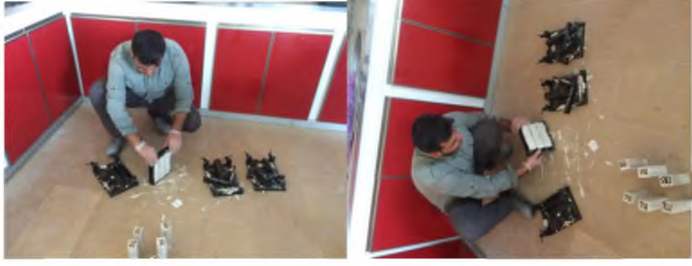
Resim 3.6. Numunelerin Kalıptan Sökülmesi
