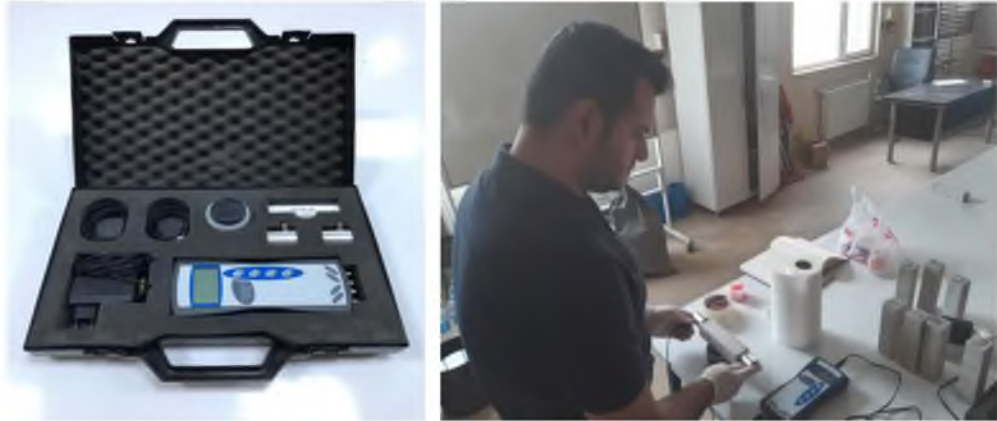
Resim 3.10. Ultrasonik geçiş hızı (UPV) test cihazı
