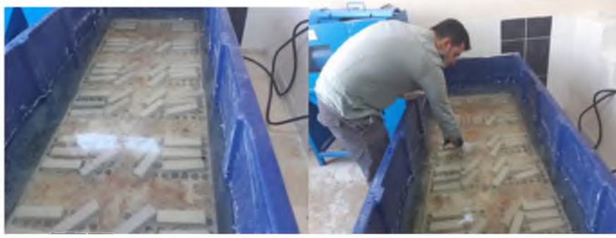
Resim 3.7. Kür havuzunda bekletilen numunelerimiz
