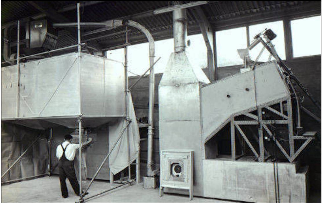
Şekil 2.14. Genleştirilmiş Vermikülit Üretiminde Kullanılan Eğimli Fırın [62].
