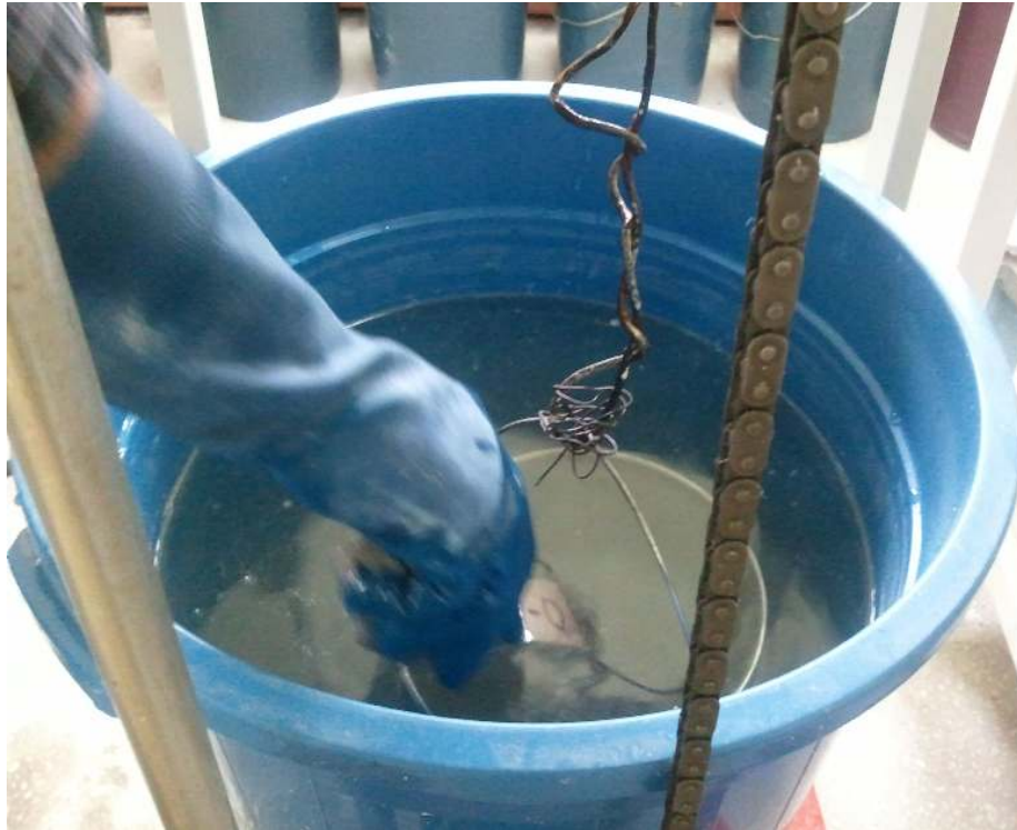
Şekil 3.14. Numunelere Arşimet Deneyi Yapılması
