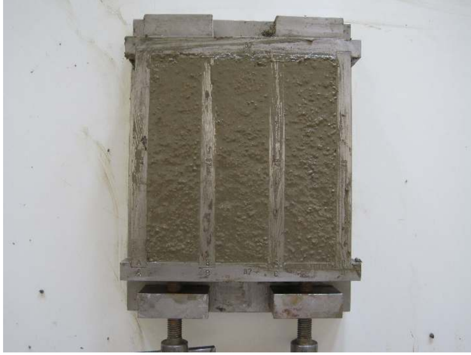
Şekil 3.8. Harcın Kalıba Yerleştirilmiş Hali
