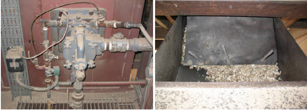
Şekil 2.13. Düşey fırında vermikülitin genişletilmesi [62]
