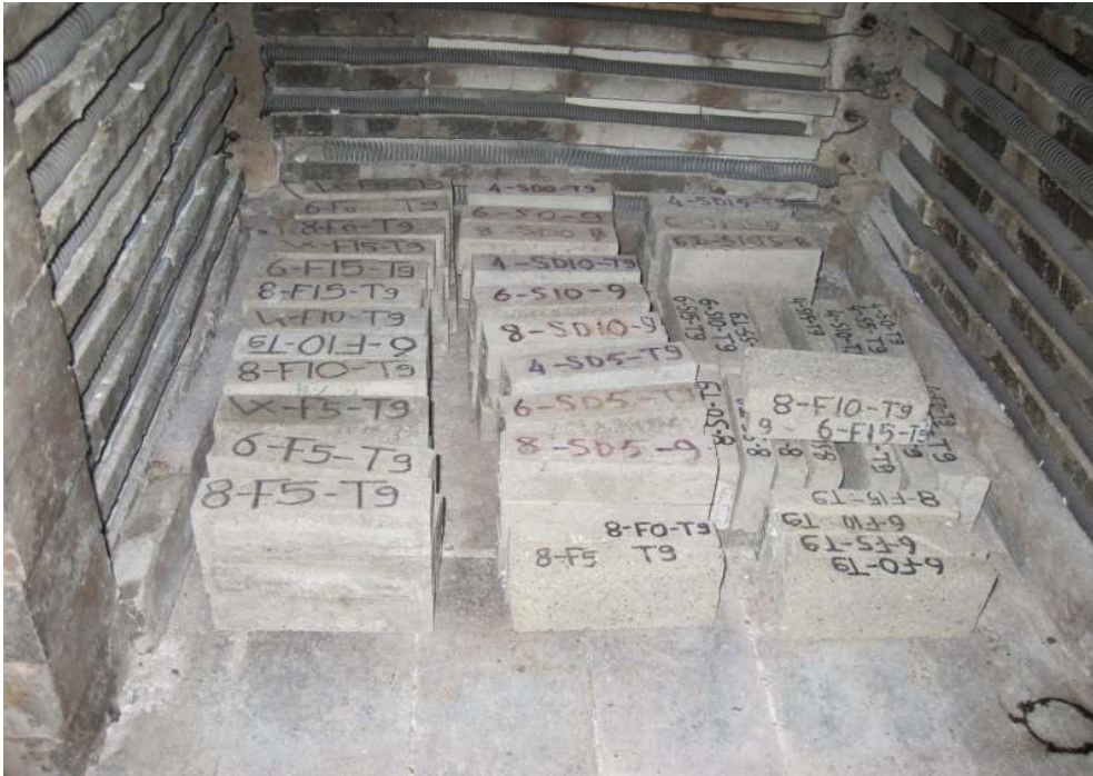
Şekil 3.11. Numunelerin Sıcaklık Uygulanmadan Önceki Durumu
