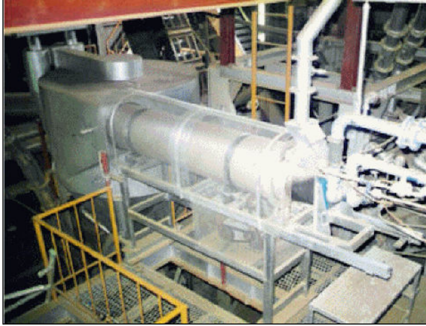
Şekil 2.15. Genleştirilmiş Vermikulit Üretiminde Kullanılan Döner Fırın [62].
