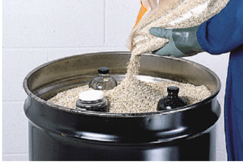
Şekil 2.23. Genleştirilmiş Vermikülitin Paketlemede Kullanımı [62].
