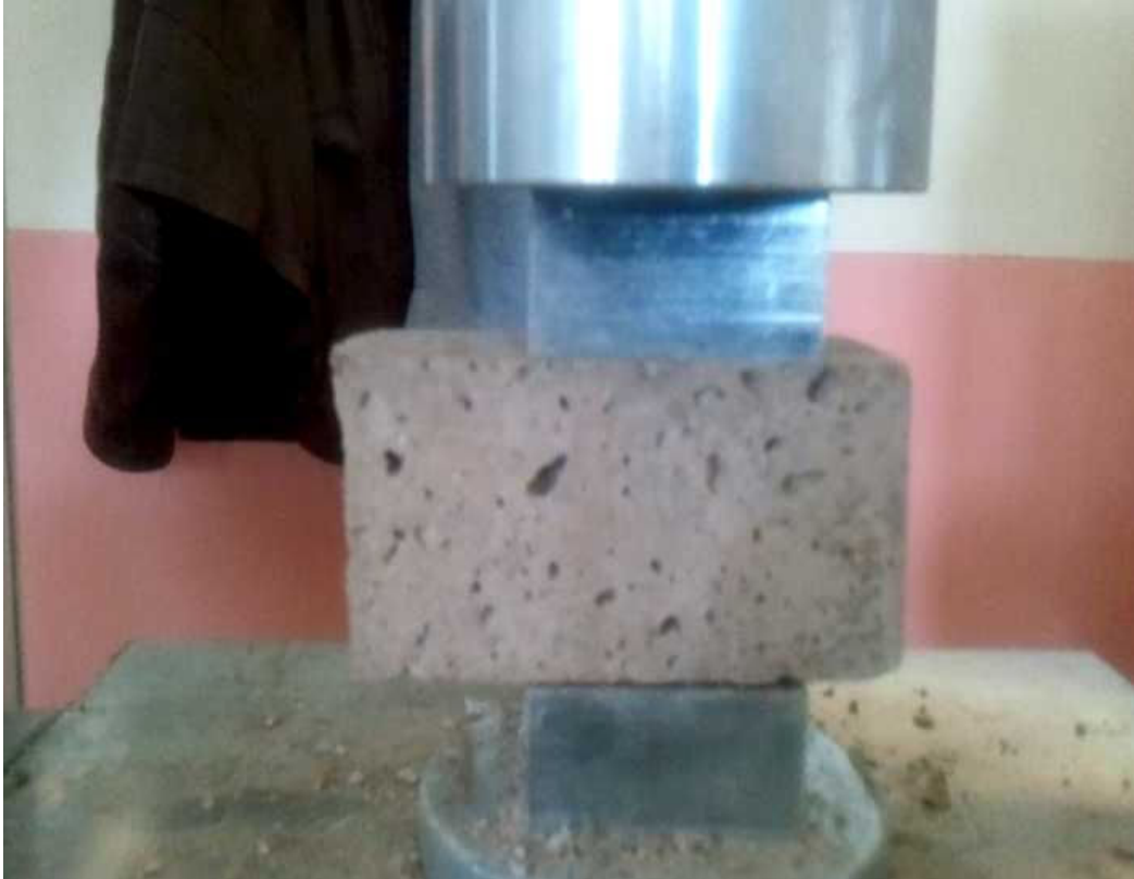
Şekil 3.17. Basınç Dayanımı Deney Düzeneği
