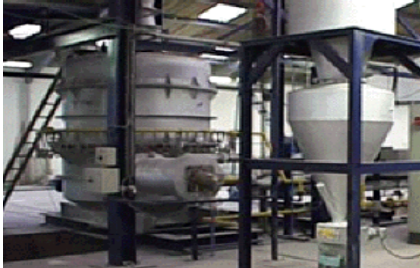
Şekil 2.16. Genleştirilmiş Vermikulit Üretiminde Kullanılan Toroidal Fırın [62].
