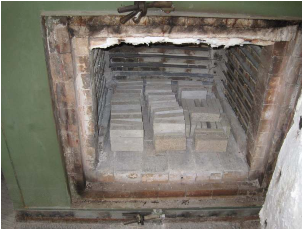
Şekil 3.12. Numunelerin Sıcaklık Uygulandıktan Sonraki Durumu
