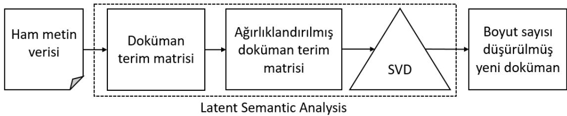
Şekil 2.3. LSA yöntemi genel yapısı [41]
