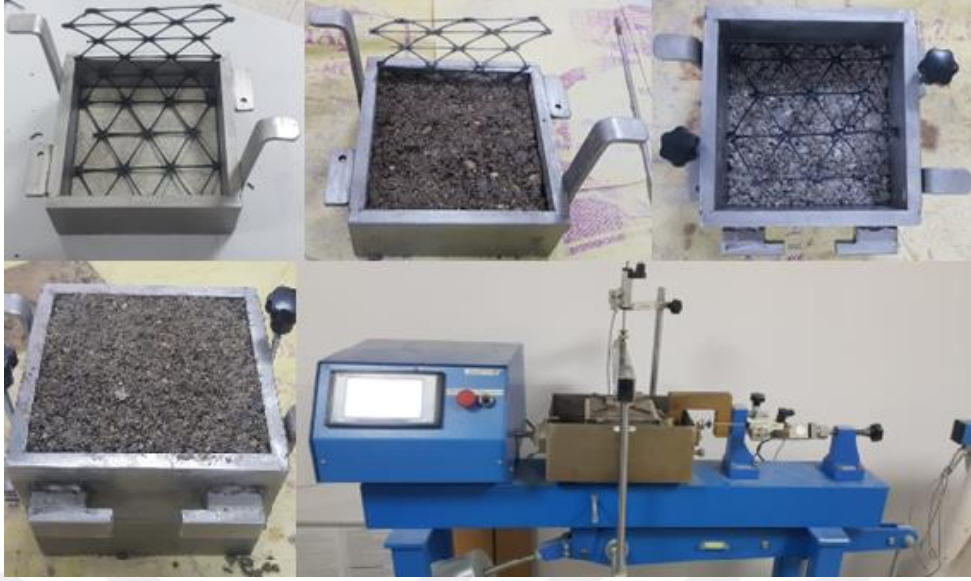
Şekil 3.18. Donatılı kesme kutusu deney aşamalar
