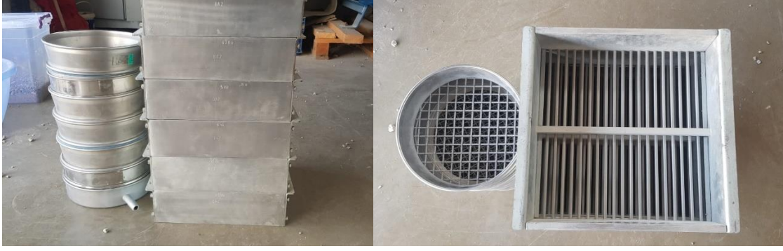
Şekil 3.14. Yassılık indeksi deneyinde kullanılan elekler (kare göz açıklıklı elekler, silindirik çubuklu elekler)
