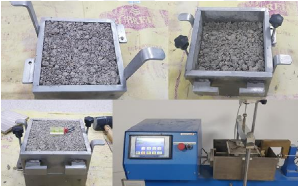
Şekil 3.17. Donatısız kesme kutusu deney aşamaları
