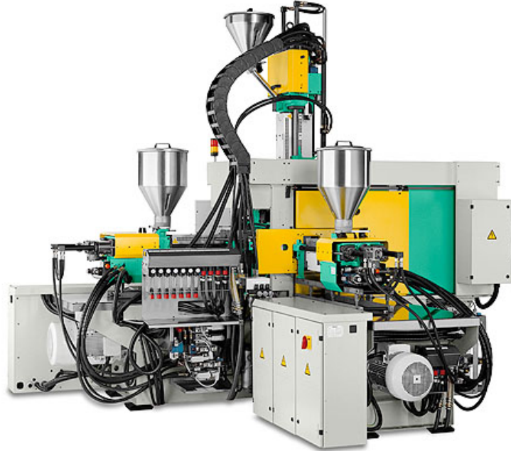
Şekil 3.41 Çoklu enjeksiyon kalıplama makinası ( http://www.arburg.com/com/COM/en/index.jsp ).
