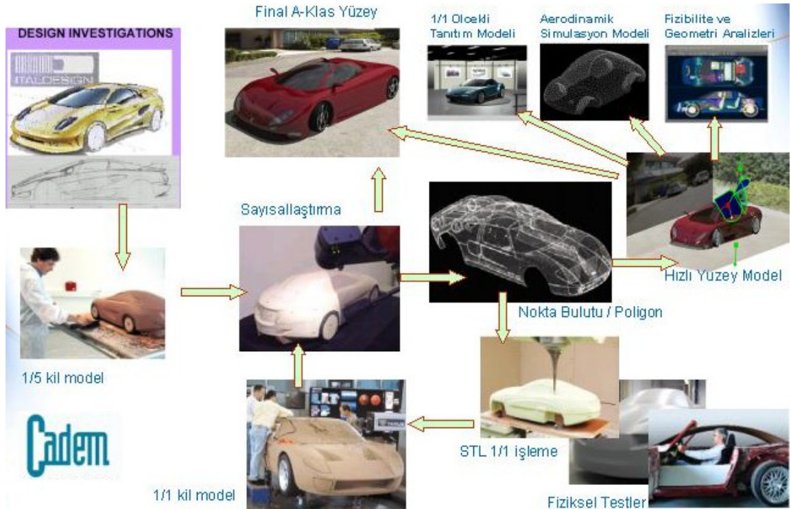
Şekil 4.47 Japon otomotiv firmaları tarafından kullanılan tersine mühendislik yöntemi adımları (Dereli ve Baykasoğlu, 2005).
