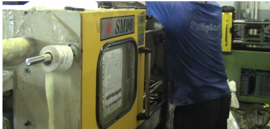
Şekil 9.75 Deneyde kullanılan enjeksiyon tezgahı.
