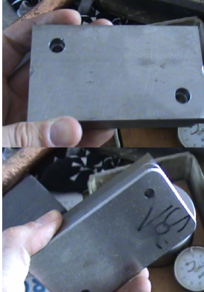
Şekil 9.30 Erkek hamili plakaya gömülecek tabanı ve erkek hamili plakaya M6 cıvata yardımıyla çekirtme için kullanılacak deliklerinin işlenmesinin tamamlanmış görünümü.
