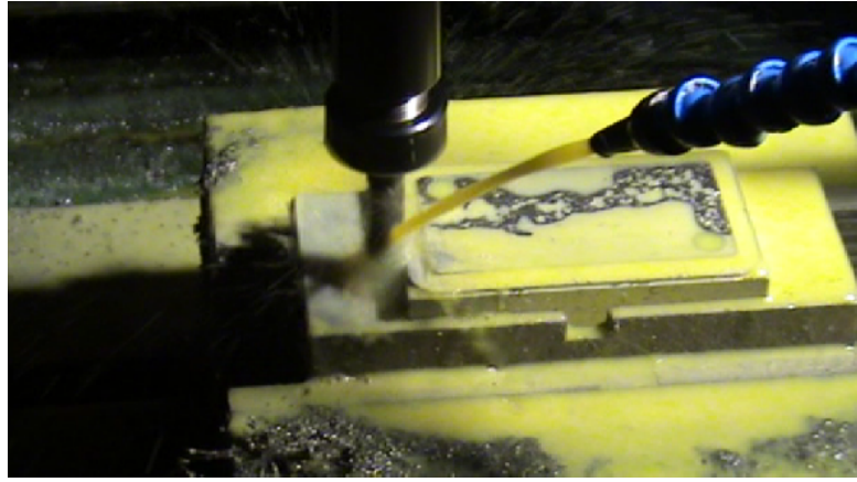
Şekil 9.32 Erkek lokmaların üst yüzeyinin ve 4^\circ açılı dik yüzeylerinin CNC dik işlem merkezinde 4 ağızlı, \varnothing 10 , köşe radyüsü 0 olan elmas parmak freze ile kaba ve hassas işlenmesi.
