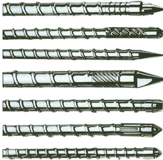
Şekil 3.20 Enjeksiyonda kullanılan helezonlar tipleri ( http://img.alibaba.com/photo/50358046/Screw_and_Barrels_for_Injection_Machine.jpg ).
