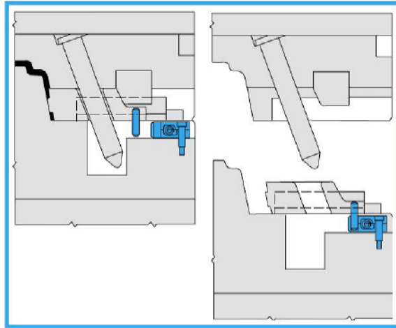
Şekil 5.71 Açılı pim sistemi ile maçaların hareketlendirilmesi ( http://www.dme.net ).
