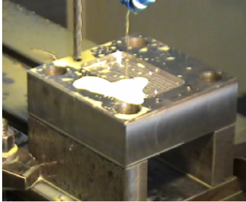
Şekil 9.68 Erkek hamili plakasına geri dönüş pim deliklerinin açılması.
