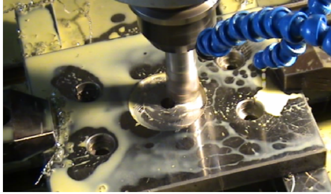
Şekil 9.62 Sabit mengene bağlama plakasına merkezleme halkasının monte edileceği deliğin CNC dik işlem merkezinde işlenmesi.
