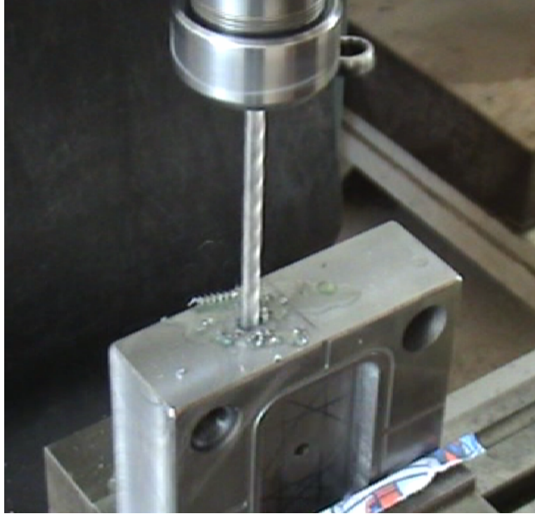
Şekil 9.58 dişi hamili plakaya ait Ø8 Soğutma kanallarının freze tezgahında açılması.
