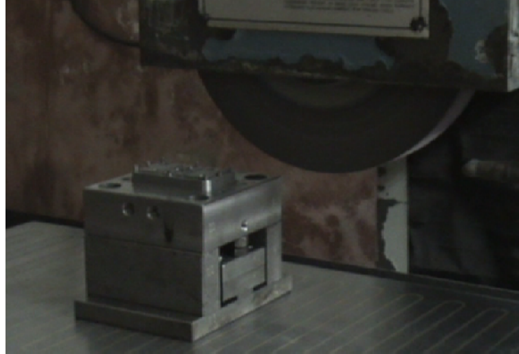
Şekil 9.72 İtici ve geri dönüş pimlerinin taşlama tezgahında tam boy a getirilmeleri.
