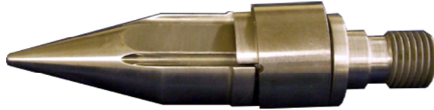
Şekil 3.27 Helezona ait yüzük-torpil sistemi montajı, ( http://www.injectionscrewtips.com/ ).
