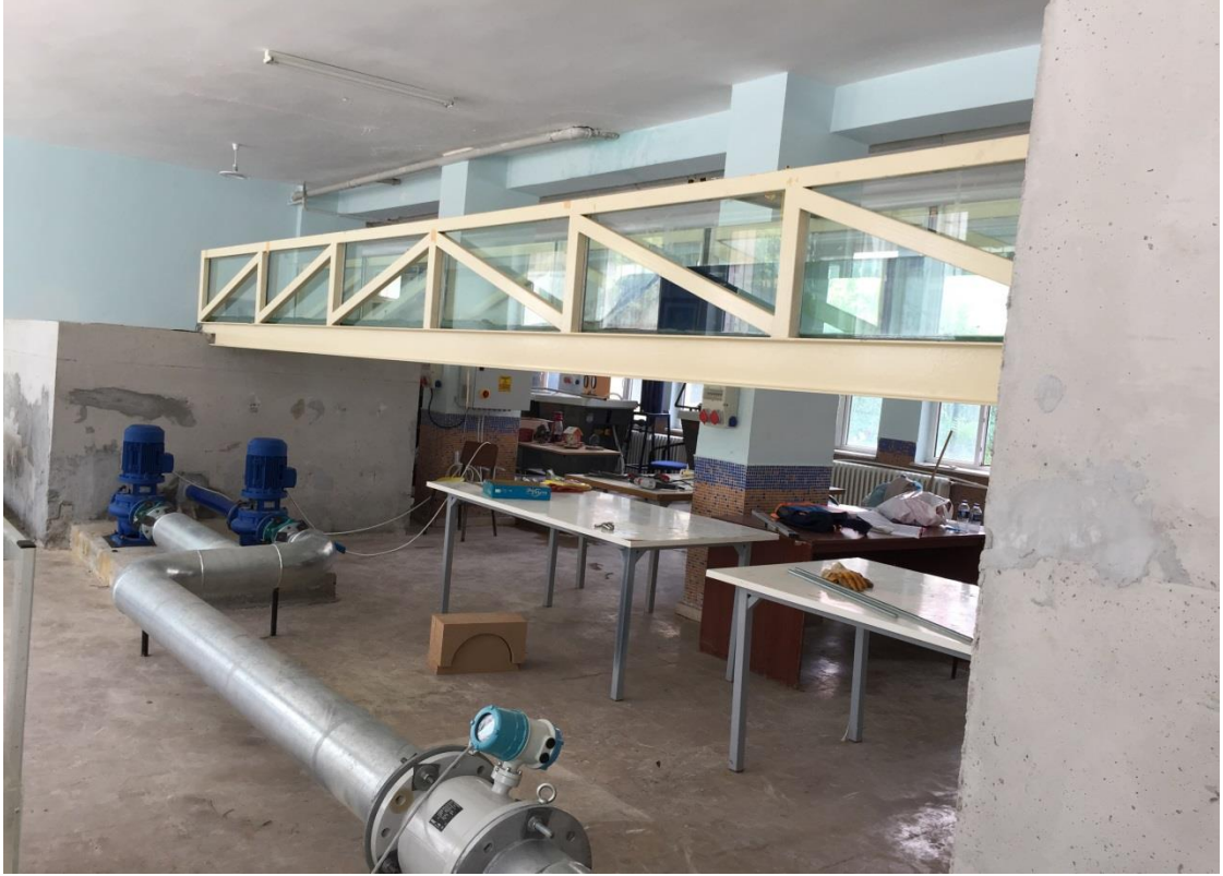
Şekil 3.20 Deneysel çalışmalarda kullanılan açık kanalın genel görüntüsü
