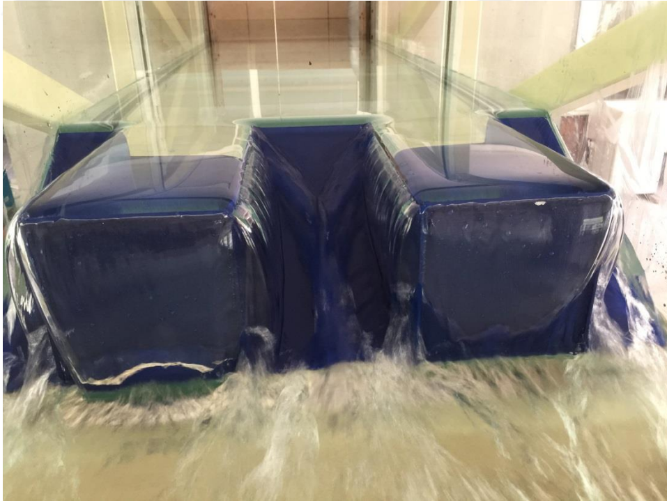
Şekil 3.41 Model 2’de Q=5.53 l/s debide oluşan akım
