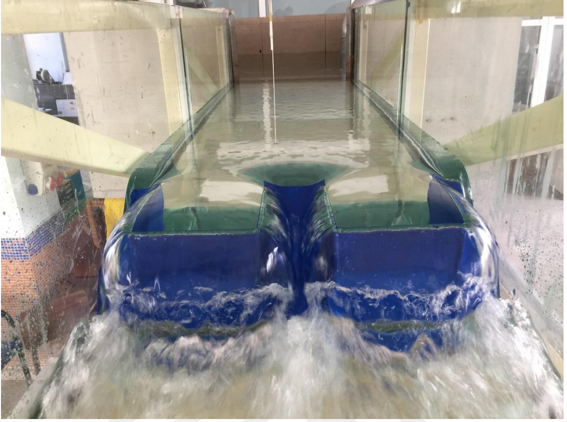
Şekil 3.50 Model 11’de Q=20.39 l/s debide oluşan akım
