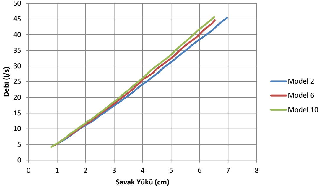
Şekil 4.6 Tip 2 savak modellerinde ölçülen Q-H değerleri
