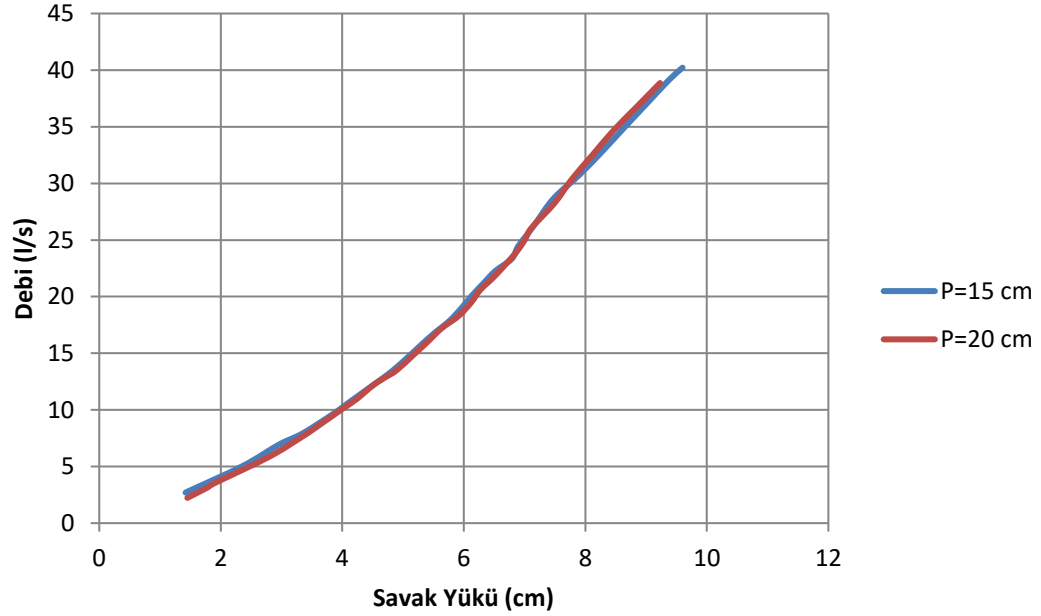
Şekil 4.9 Keskin kenarlı savak modellerinde ölçülen Q-H değerleri
