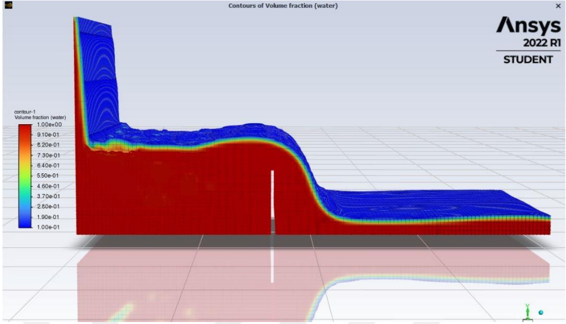
Şekil 3.72 P=15 cm keskin kenarlı savak analiz sonucu ( Q=30 l/s)
