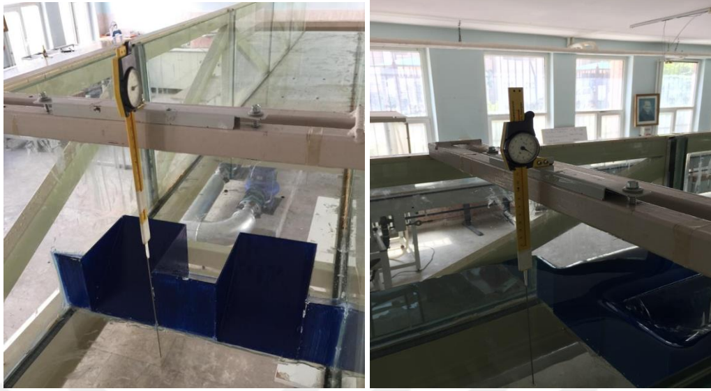
Şekil 3.23 Su yüksekliğinin ölçülmesi ve kullanılan limnimetre
