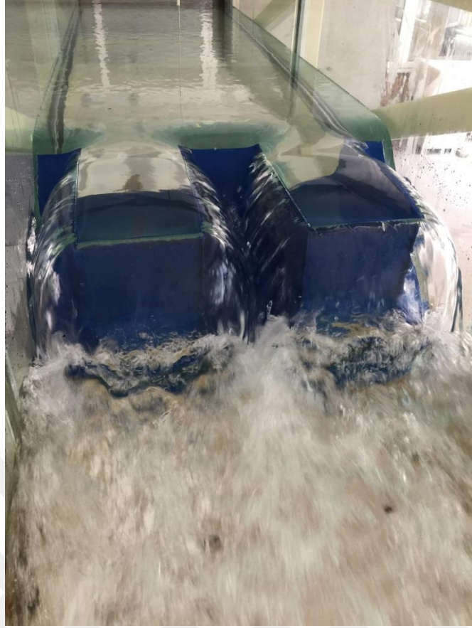
Şekil 3.40. Model 1’de Q=25.45 l/s debide oluşan akım
