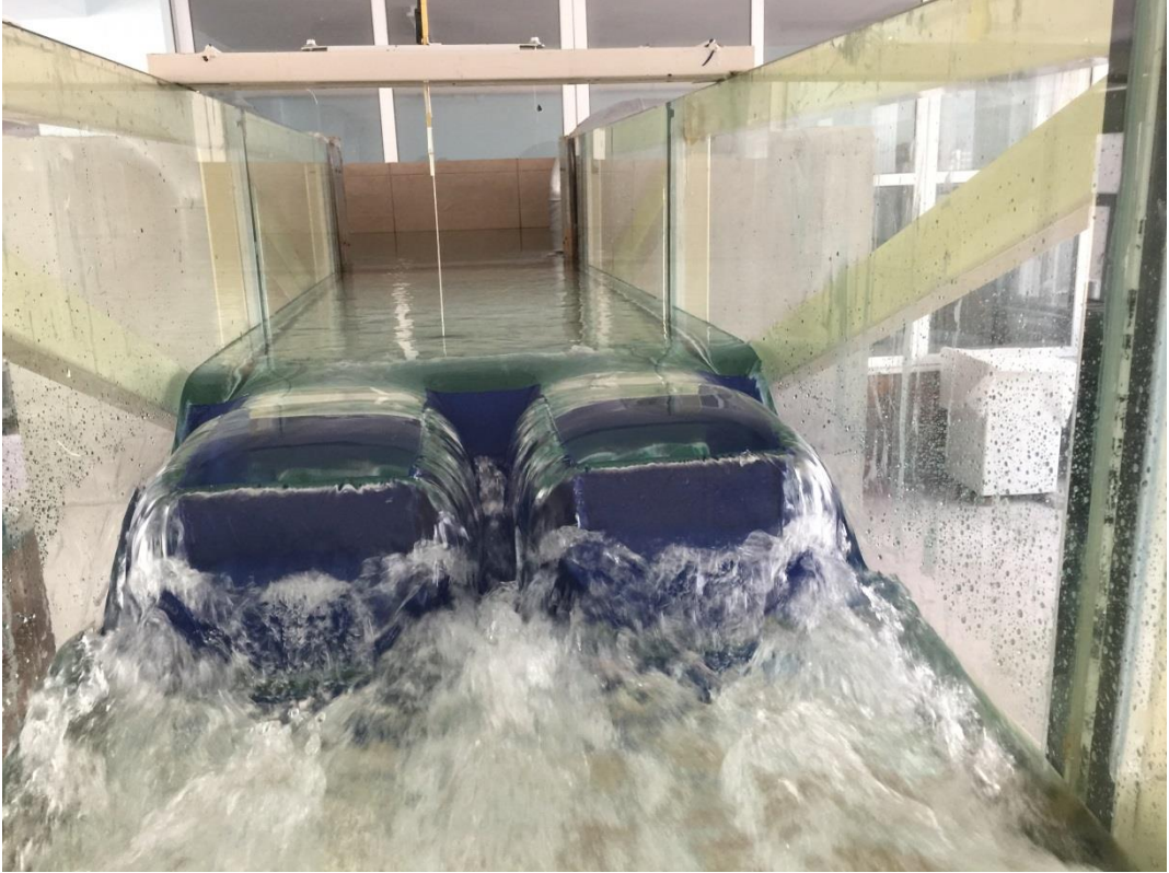
Şekil 3.45 Model 6'da Q=25.82 l/s debide oluşan akım
