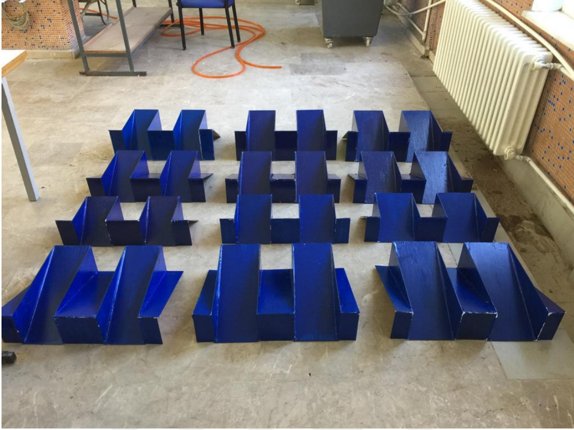
Şekil 3.24 MDF'den imal edilmiş PKW modelleri
