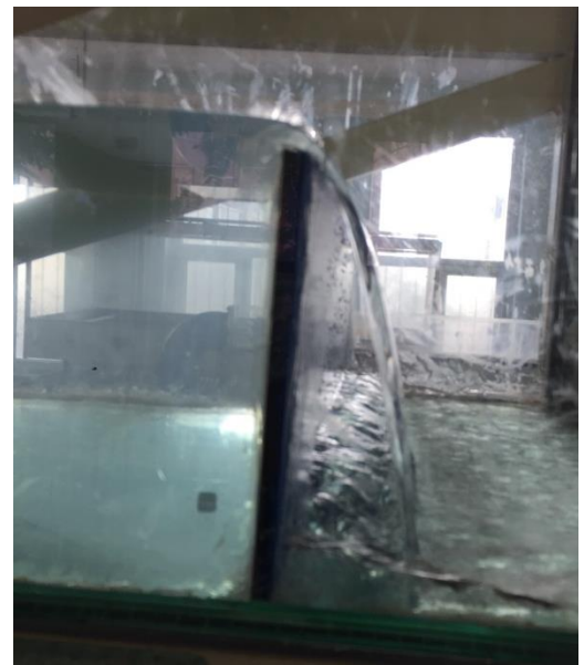
Şekil 4.28 P=20 cm keskin kenarlı savakta deneysel ve nümerik model karşılaştırması ( Q=5 l/s)
