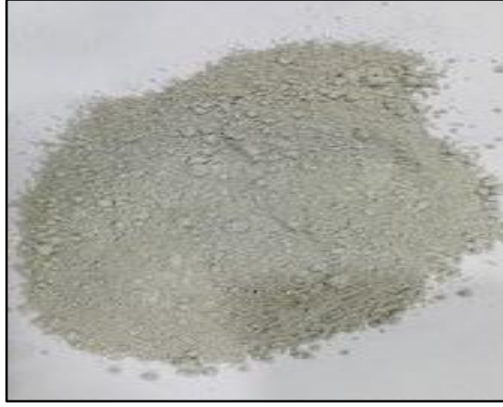
Şekil 3.1. Öğütülmüş granül yüksek fırın cürufu (YFC)
