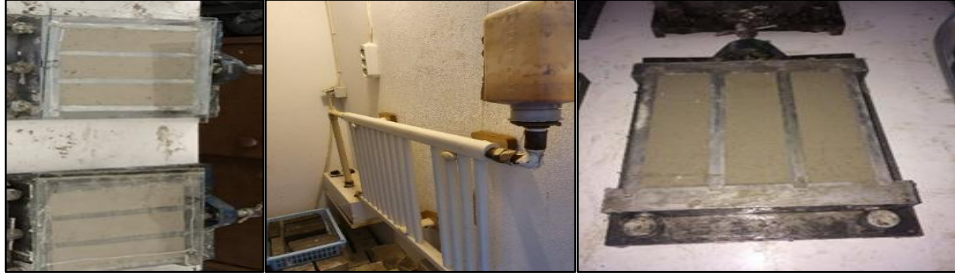
Şekil 3.10. Beton döküm ve buhar kürü
