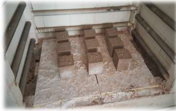
Resim 3.9 Yüksek sıcaklığa maruz bırakılan geopolimer beton numunelerin son halleri.
