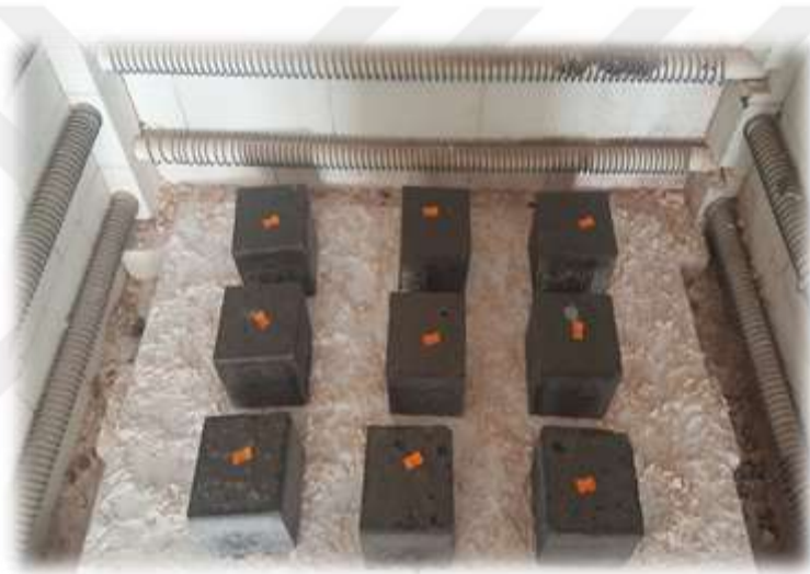
Resim 3.8 Yüksek sıcaklığa maruz bırakılan geopolimer beton numunelerin ilk halleri.
