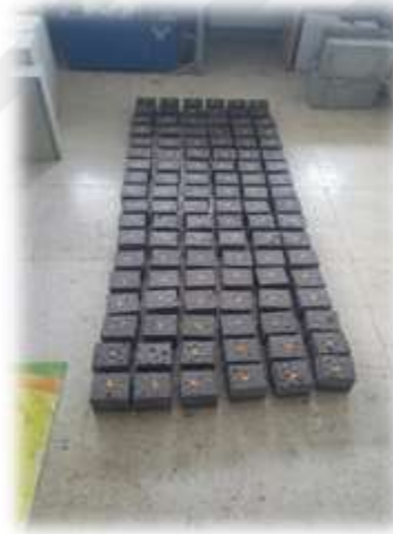
Resim 3.4 Etüv kürü uygulanmış geopolimer betonlar.
