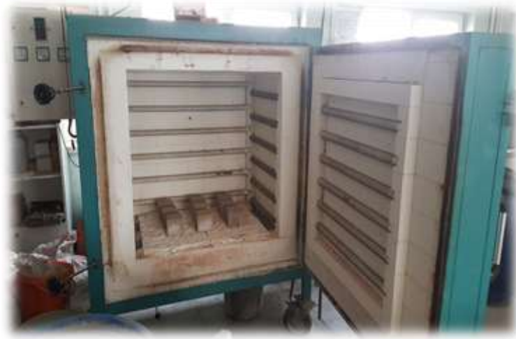
Resim 3.7 Yüksek sıcaklık deneyinde kullanılan fırın.
