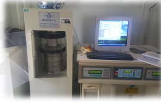
Resim 3.5 Çalışmada kullanılan beton presi.
