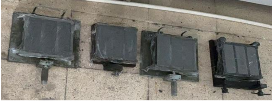
Şekil 3.5. Harçların kalıplara yerleştirilmesi
