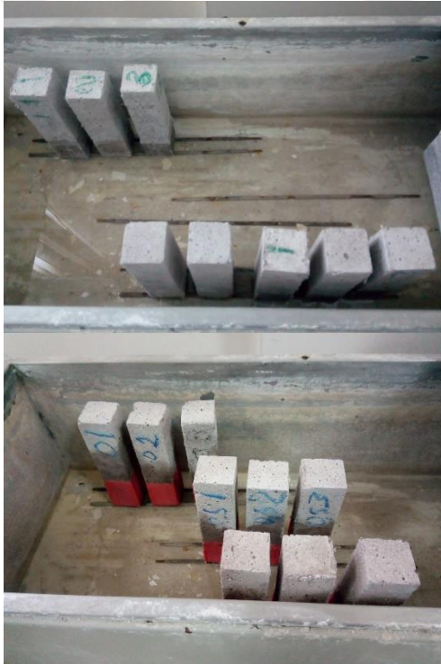
Şekil 3.11. Kılcal su emme testi kurulumu
