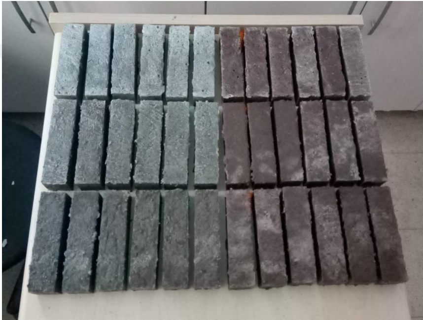
Şekil 3.6. Kalıptan çıkarıldıktan sonra bekletilen numuneler
