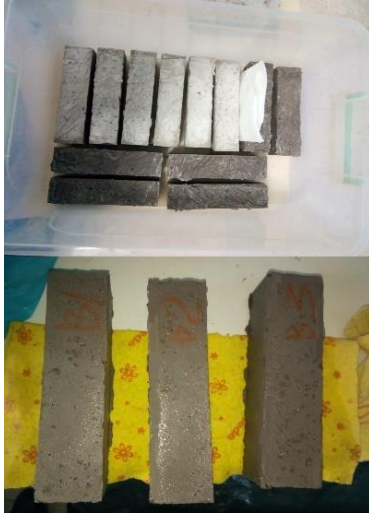
Şekil 3.10. Kılcal su emme deneyinden önce suya bırakılan ve sudan çıkartılan numuneler
