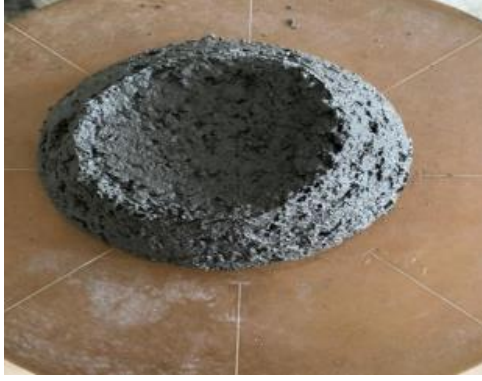
Şekil 3.7. Taze harç kıvam deneyi
