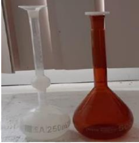
Şekil 3.3. Le Chatelier balonu ve balon Joje
