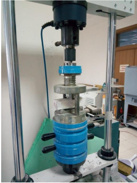
Şekil 3.9. UTEST cihazı ile eğilme dayanımı tayini
