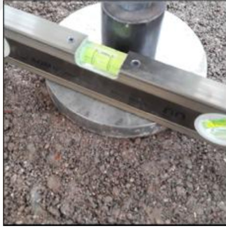
Şekil 3.41. Model Temelin Yerleştirilmesi İşlemi
