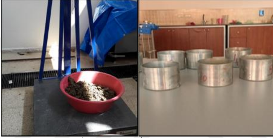
Şekil 3.36. Ağırılık ve Su İçeriği Kontrolü İşlemi
