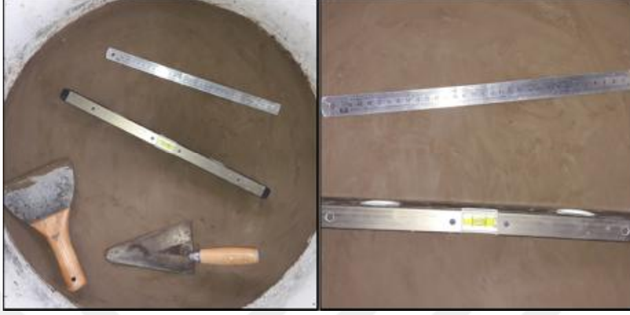
Şekil 3.38. Yüzey Düzgünlüğü Kontrolü
