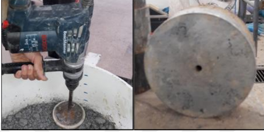
Şekil 3.34. Sıkıştırma Ekipmanları (Hilti ve Tokmak)
