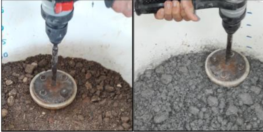
Şekil 3.39. Granüler Malzemelerin Sıkıştırılma İşlemi (CDW ve PMT)
