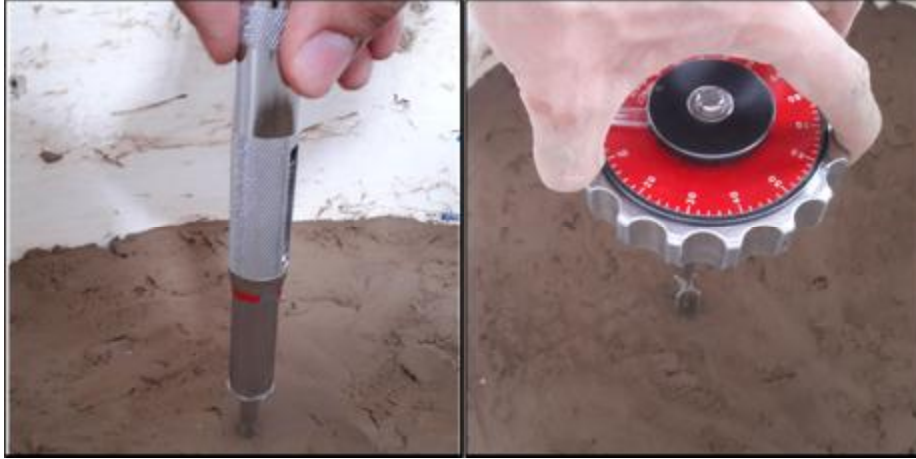
Şekil 3.37. Mukavemet Kontrolü İşlemi (Vane ve Penetrometre Deneyi)
