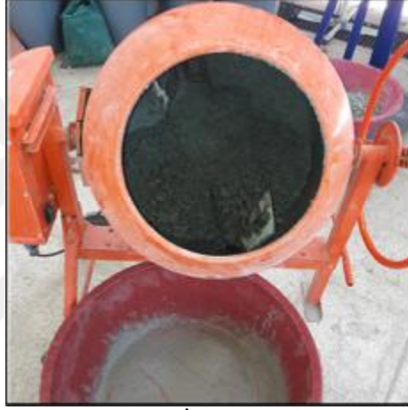
Şekil 3.35. Mikserde Su ile Karıştırma İşlemi
