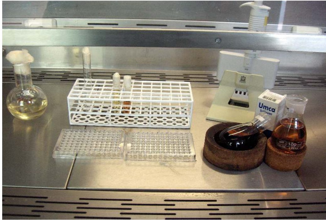
Resim 5. Mikropleyt kuyularına bakteri ve fungus kültür süspansiyonlarından ilave edilirken kontaminasyonu önleme amaçlı kullanılan laminar akım cihazı
