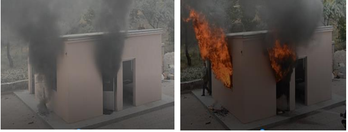
Şekil 3.14. Oturma odası yangın pencere camı patlama ve parlama görselleri
