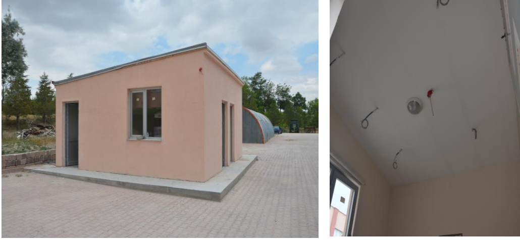
Şekil 3.4. Deney binası termokupl yerleşimi
