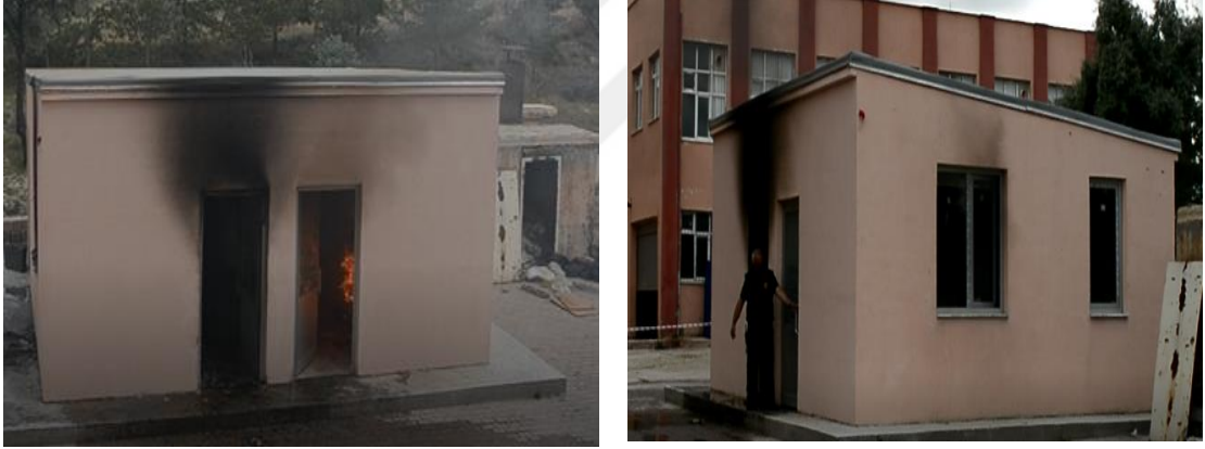
Şekil 3.17. Yatak odası deneyi 1 dakika 35. Saniye sonraki görselleri
