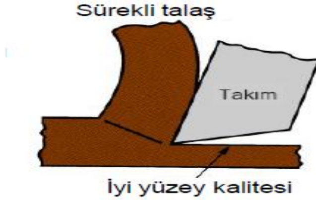
Şekil 2.4. Sürekli talaş tipi
