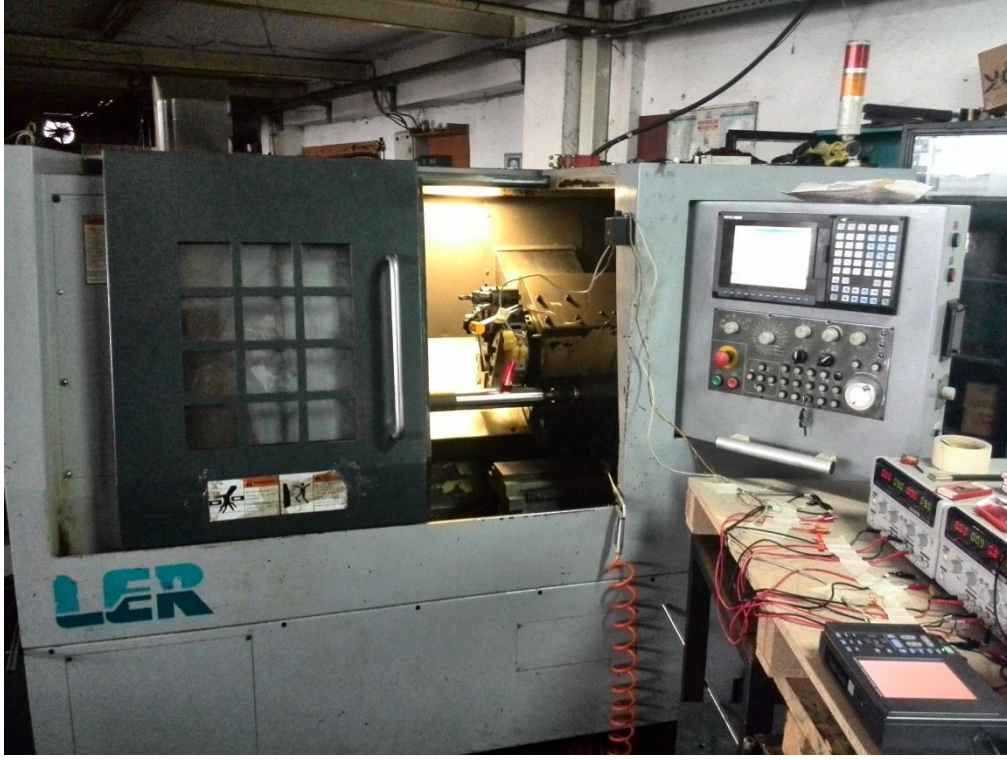
Şekil 8.1. Deneyisel çalışmada kullanılan Ler. Tc. 150B CNC torna tezgahı
