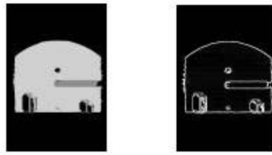
Şekil 2. 18 Gri seviye bir görüntü ve Sobel Operatörü ile bulunan kenarları
