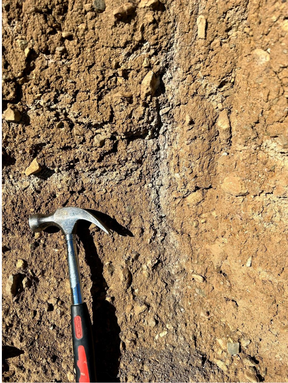
Şekil 4.35. Gerede batısında İbricak civarındaki alüvyal kayalar içinde gelişmiş sıvılaşma yapıları
