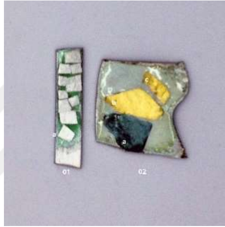
Şekil 70: Mine ile yapıştırma denemeleri
