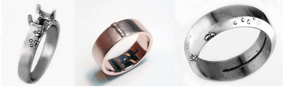
Şekil 50: Hatalı dökümde dolgu yöntemleri
