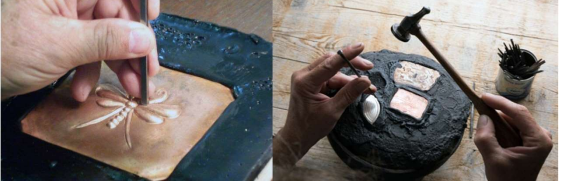
Şekil 25: Kabartma zifti üzerinde rölyef çalışması
