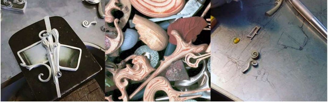
Şekil 41: Çeşitli modellerden kalıp almaya hazırlık
