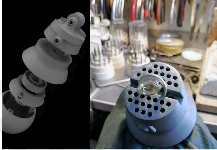
Şekil 65: Kalemkar ve mihlayıcı toplu mengenesi
