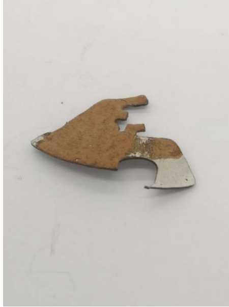
Şekil 72: Metal üzerine kil kaynaştırma denemesi
