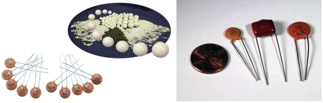
Şekil 20: Seramik elektronik devre elemanları ve porselen küreler
