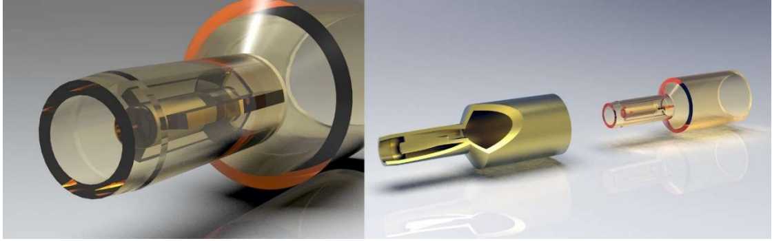
Şekil 76: Ekstrüzyon (enjeksiyon) ucu illüstrasyonu
