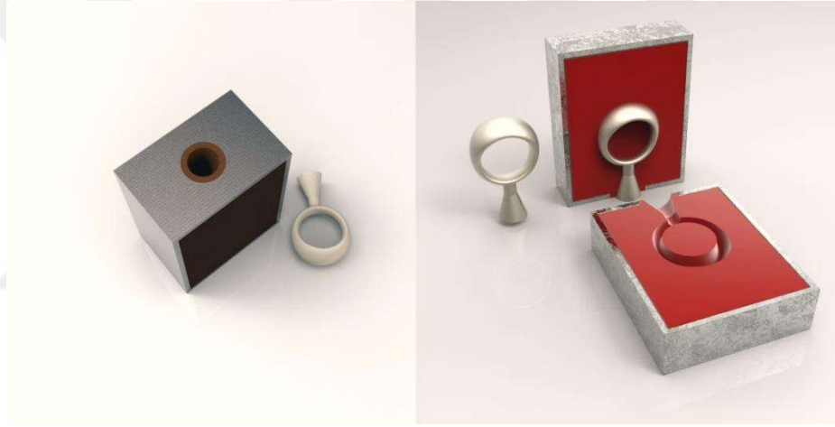
Şekil 40: Mum enjeksiyon kalıbı illüstrasyonu
