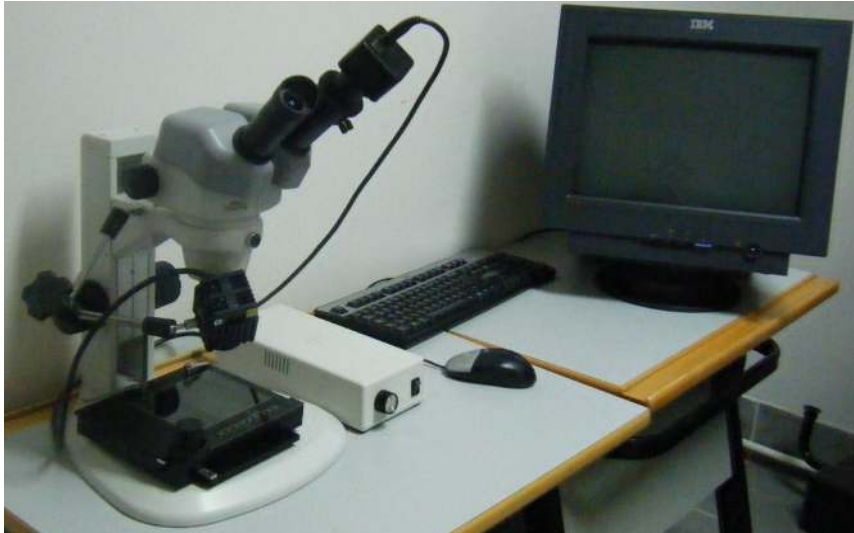
Şekil 6.27 Nikon SMZ645 marka stereo ışık mikroskobu
