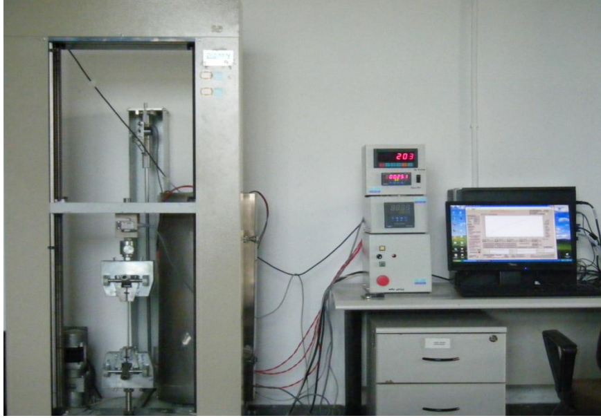
Şekil 6.11 MARES marka, TST-SE-J-2T model üniversal çekme makinası
