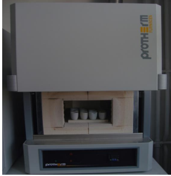
Şekil 6.25 Protherm marka, “PLF 120/5” model kül fırını
