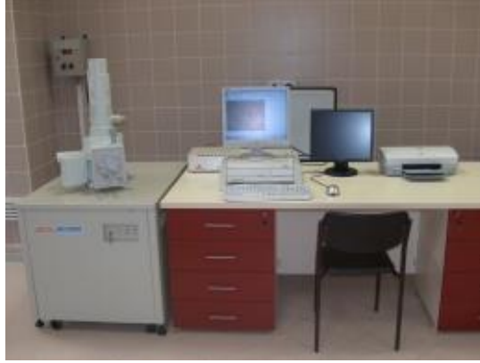
Şekil 6.41 JEOL 6060 marka Tarama Elektron Mikroskobu (SEM)
