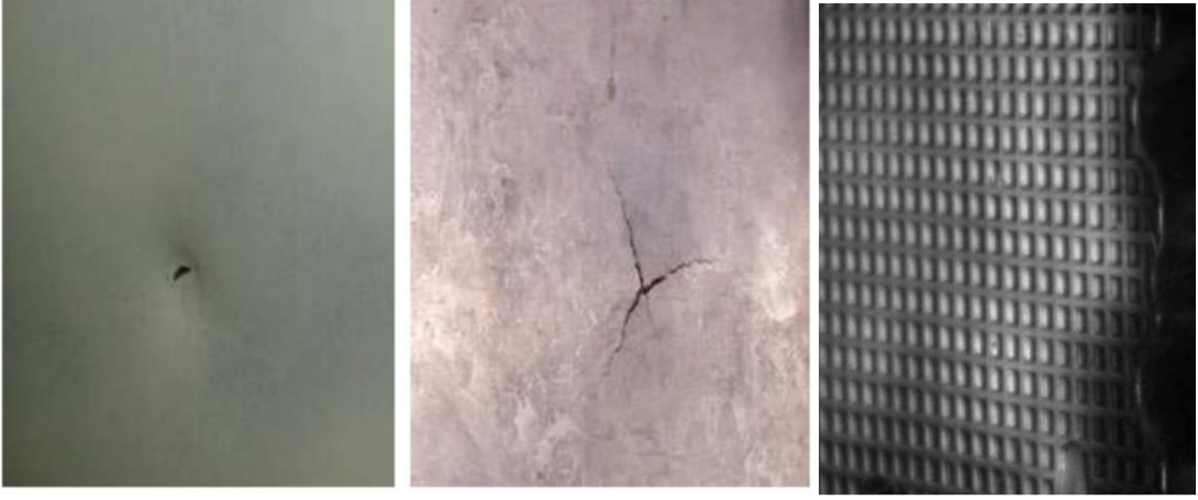
Şekil 5.6 Sırasıyla çelik, alüminyum alaşımı ve PP matrisli kompozitten üretilmiş yağ karterlerinin standart darbe (çarpma) deneyi sonuçları
