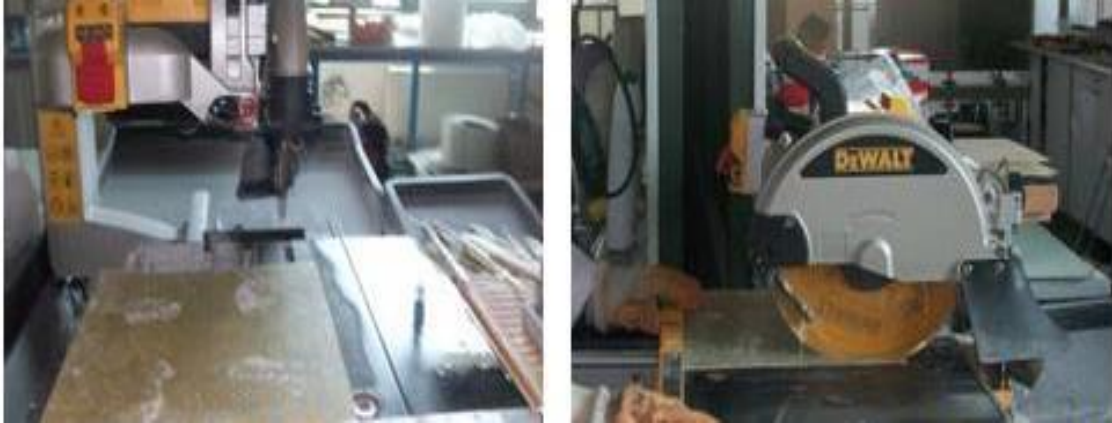
Şekil 6.36 DEWALT marka döner diskli testere ve elmas kesme diski
