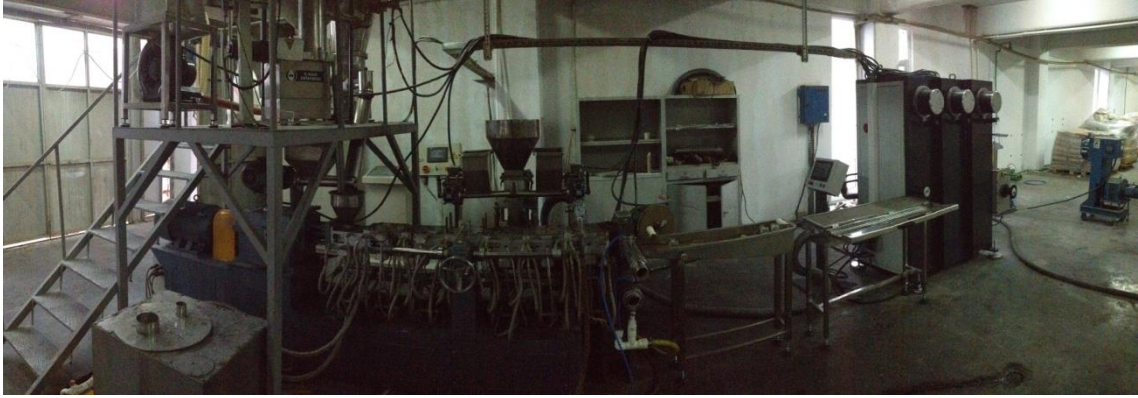
Şekil 6.2 Çift vidalı ekstrüderin çalışır haldeki panoramik görüntüsü
