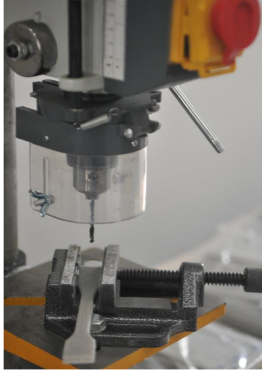
Şekil 6.13 Kaşık numunelerine pim deliklerinin delinmesi işlemi
