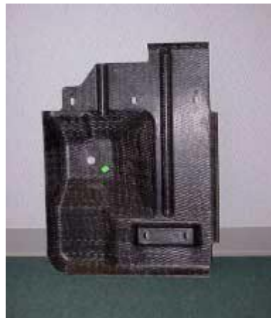
Őekil 5.3 PP – E-Camından retilmiŐ motor altı koruyucusu [78]
