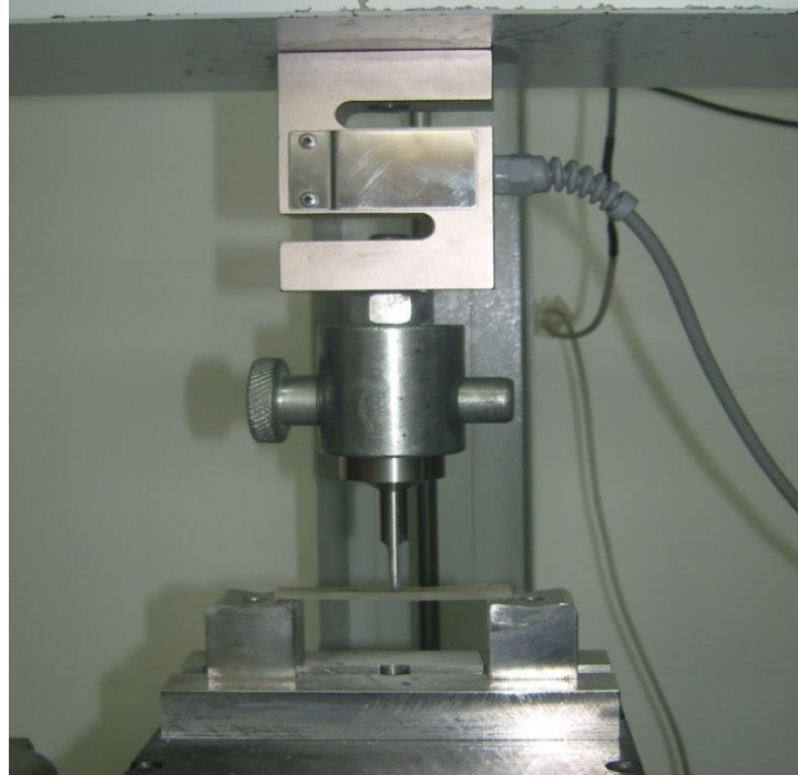
Şekil 6.17 TS EN ISO 14125 standardına göre üç noktalı eğme deneyinin yapılışı
