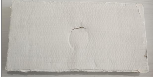
Şekil 3.9. Nem testi sonrası likit membranlı numunede yüzey kırılmaları.
