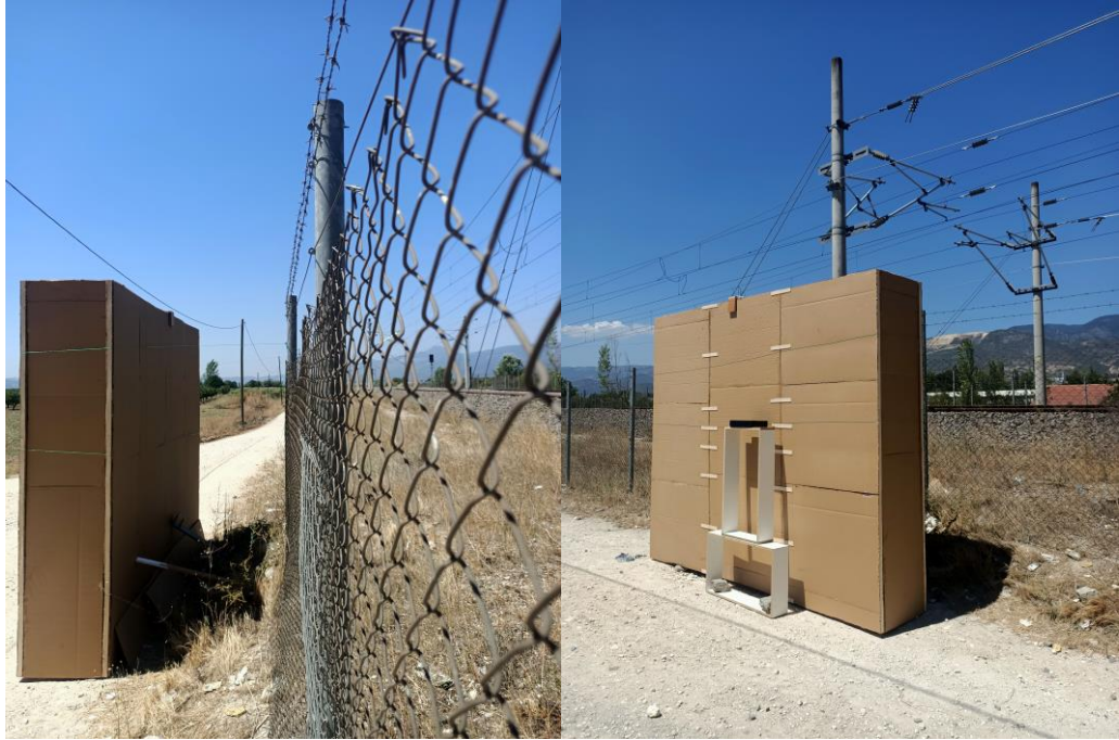
Şekil 4.36. Kutu bariyer prototipi ile yapılan gürültü ölçümleri.
