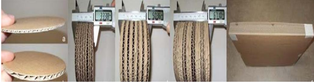
Şekil 1.8. E ve C tipi oluklu mukavvalarla üretilen sandviç panel numuneler (Asdrubali ve ark, 2015).
