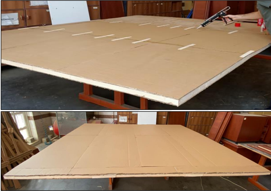
Şekil 3.18. Çift dalga oluklu mukavvanın 2 kat uygulanması.
