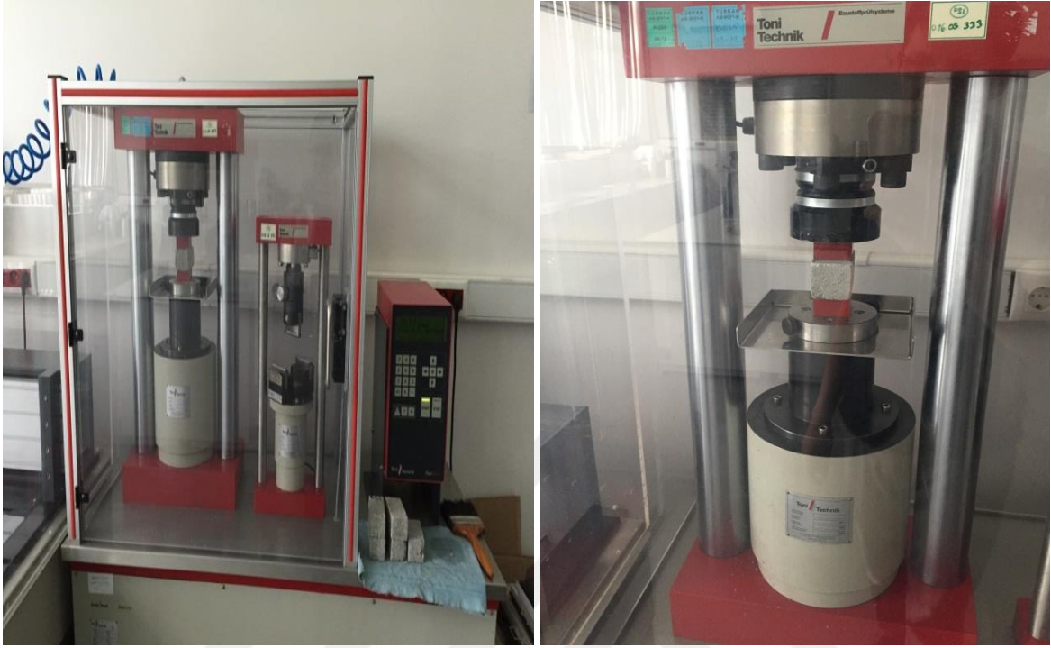
Şekil 3.11: Numunelerde basınç dayanım deneyi.
