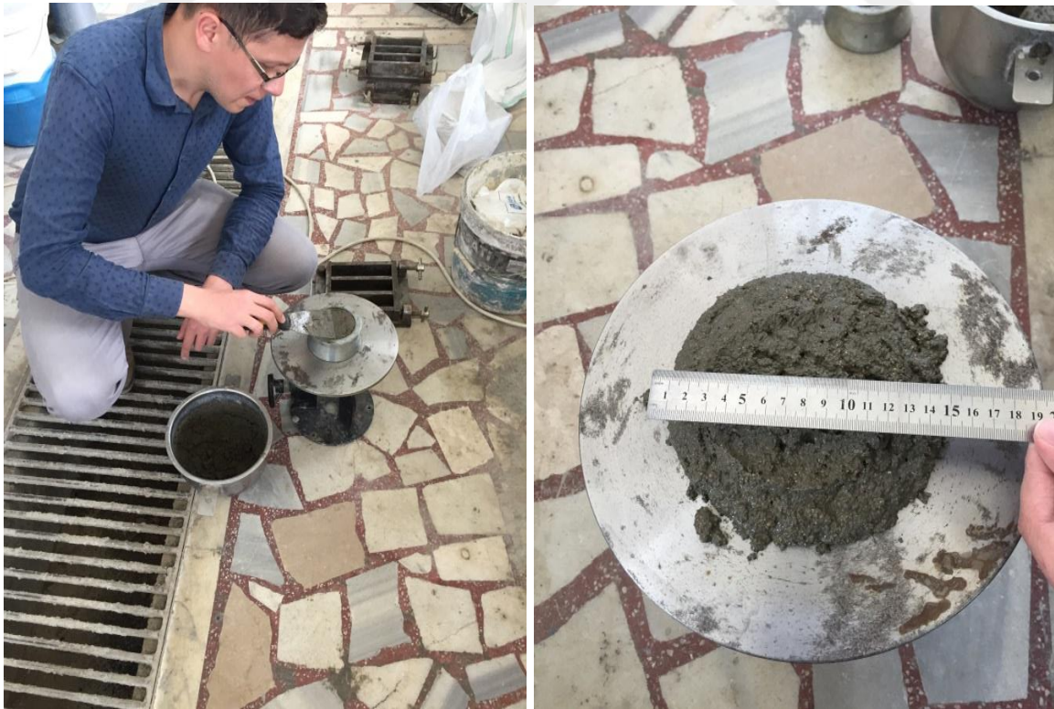
Şekil 3.7: Harçlarda yayılma çaplarının belirlenmesi.
