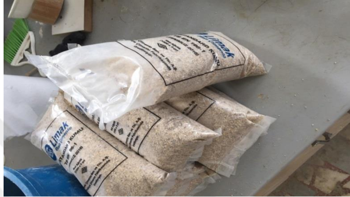
Şekil 3.2: Harç yapımında kullanılan standart kum.
