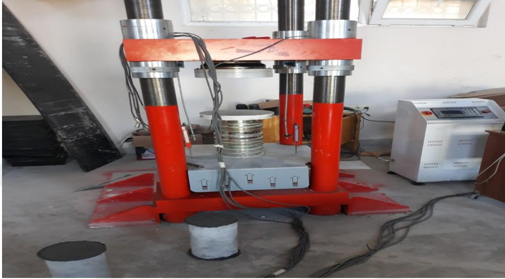
řekil 3.15: Elastisite modülünün belirlenmesinde kullanılan deney düzeneęi.
