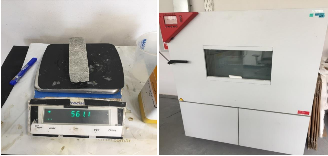
Şekil 3.8: Numunelerin etüvde kurutulması ve tartılması.
