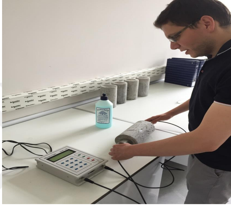
Şekil 3.12: Numune üzerine jel sürülmesi ve ultrases geçiş süresinin belirlenmesi.
