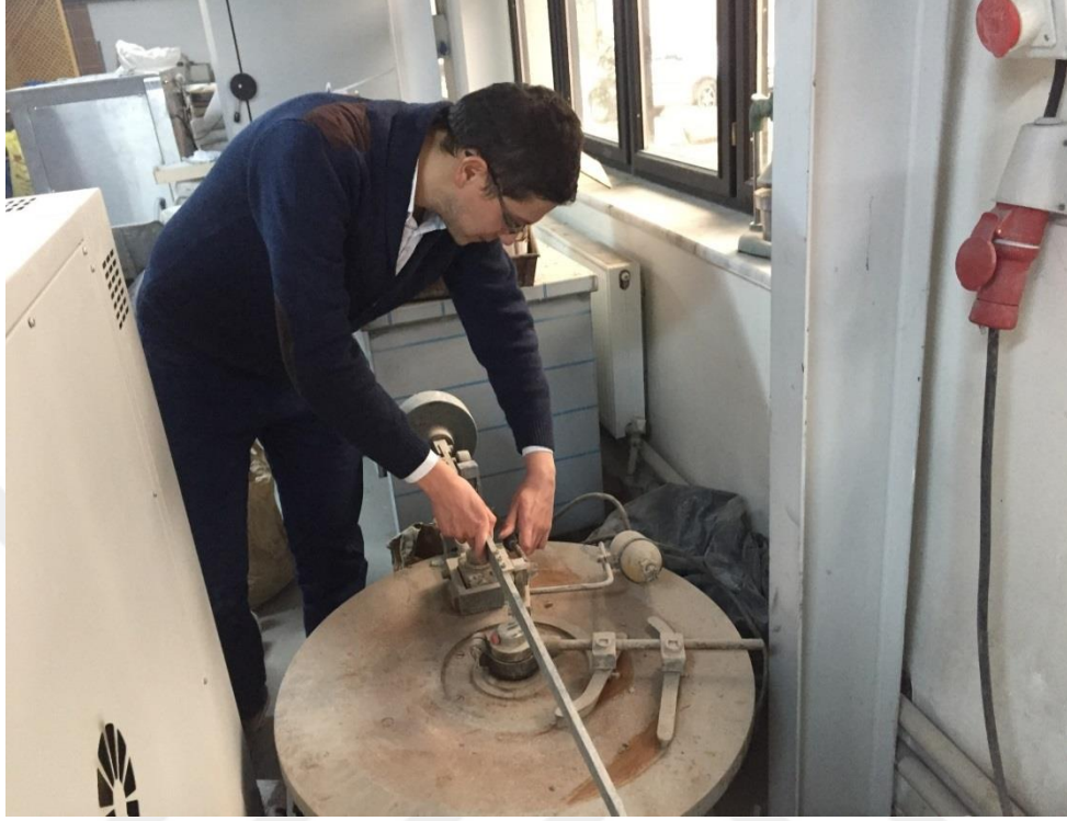
Şekil 3.14: Aşınma (Böhme) Deney Düzeneği.
