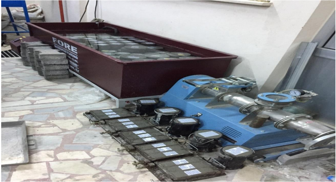
Şekil 3.6: Harçların kalıplara yerleştirilmesi ve kür havuzu.
