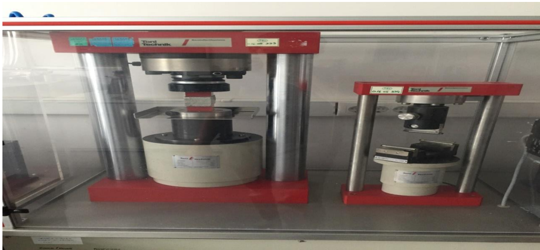
Şekil 3.9: Donma-çözülme uygulanan numunelerde basınç dayanımı tespiti.
