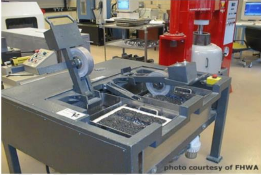
Şekil 11. Tekerlek izi düzeneği (Stuart,Youtcheff,2001)
