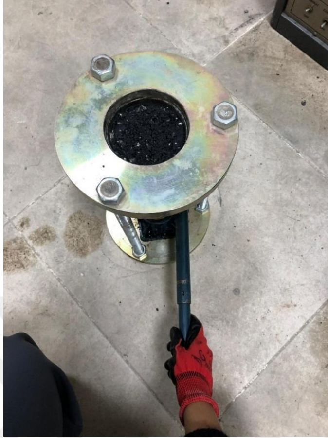
Şekil 3.30. 24 saat bekletilen numunenin kalıptan çıkarılması
