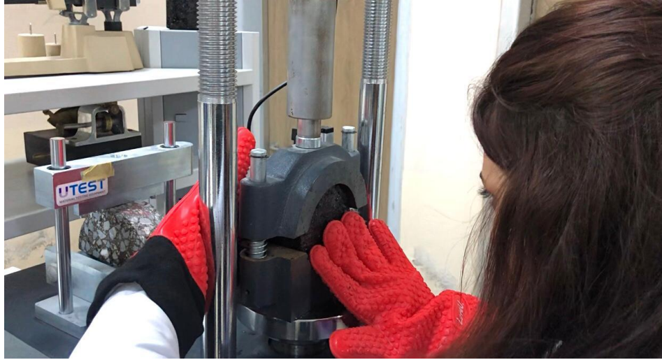
Şekil 3.39. Briketin Marshall test cihazına yerleştirilmesi
