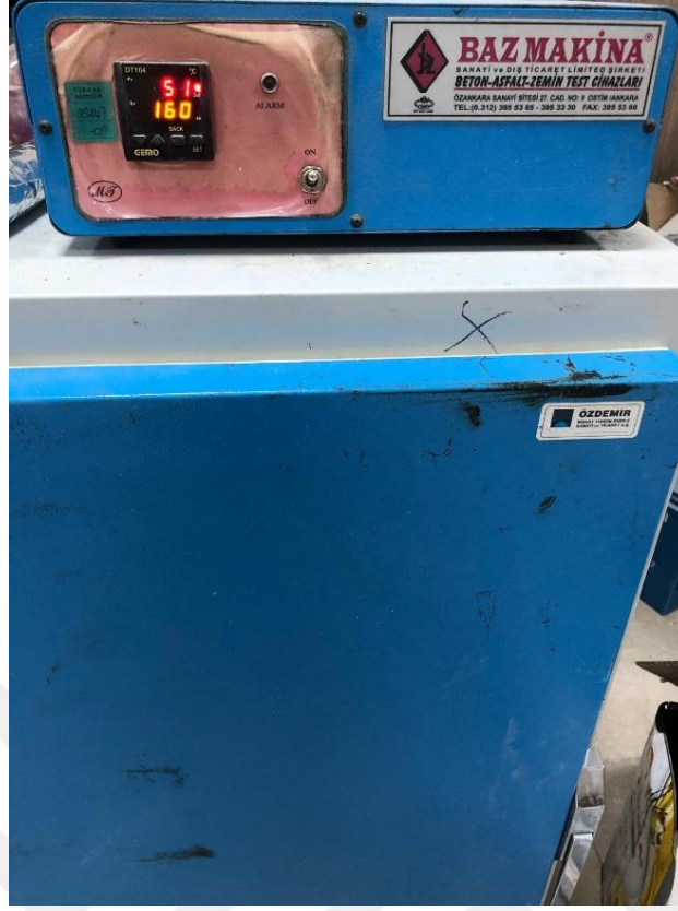
Şekil 3.20. Etüvün uygun sıcaklığa getirilmesi
