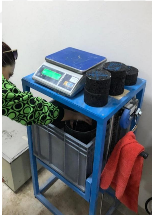
Şekil 3.34. Briketlerin sudaki ağırlığının ölçülmesi
