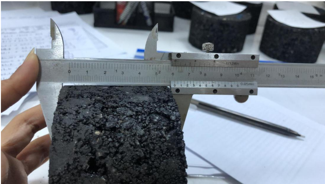
Şekil 3.32. Kumpas yardımı ile briket kalınlığı ölçümü
