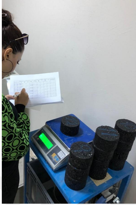
Şekil 3.33. Briketlerin havadaki ağırlığının ölçülmesi
