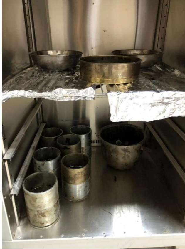
Şekil 3.21. Isıtılmaya bırakılan kalıplar, karıştırma kabı
