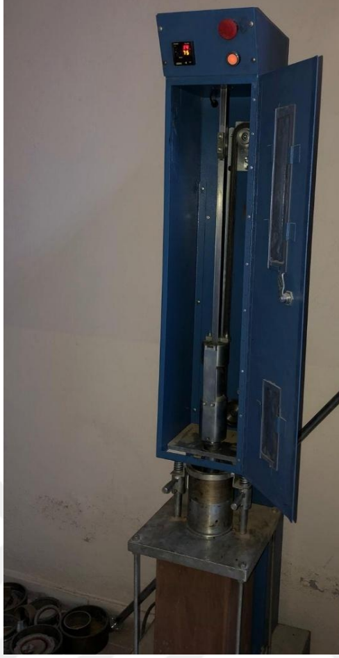
Şekil 3.28. Marshall tokmağında briketlere darbe uygulaması
