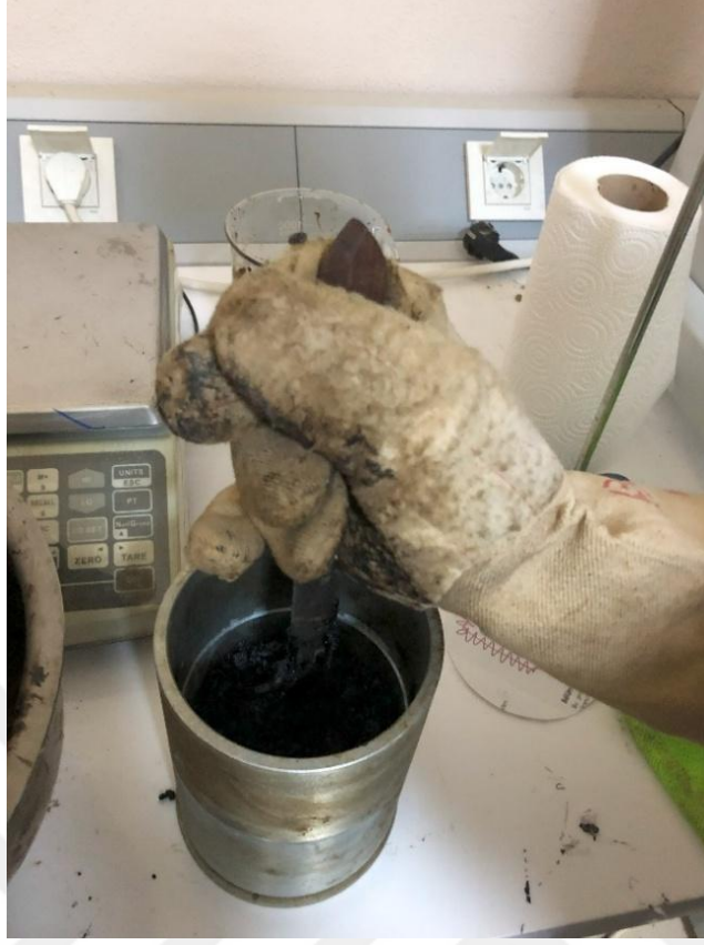
Şekil 3.26. Karışımın briket kalıplarına yerleştirilmesi
