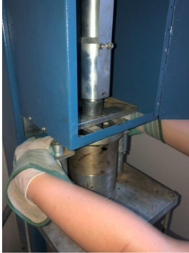
Şekil 3.27. Briket kalıbının Marshall tokmağı cihazına yerleştirilmesi
