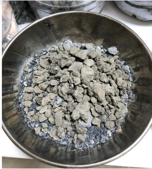
Şekil 3.19. Agrega ve RAP’in ısıtma işlemi için hazırlanması
