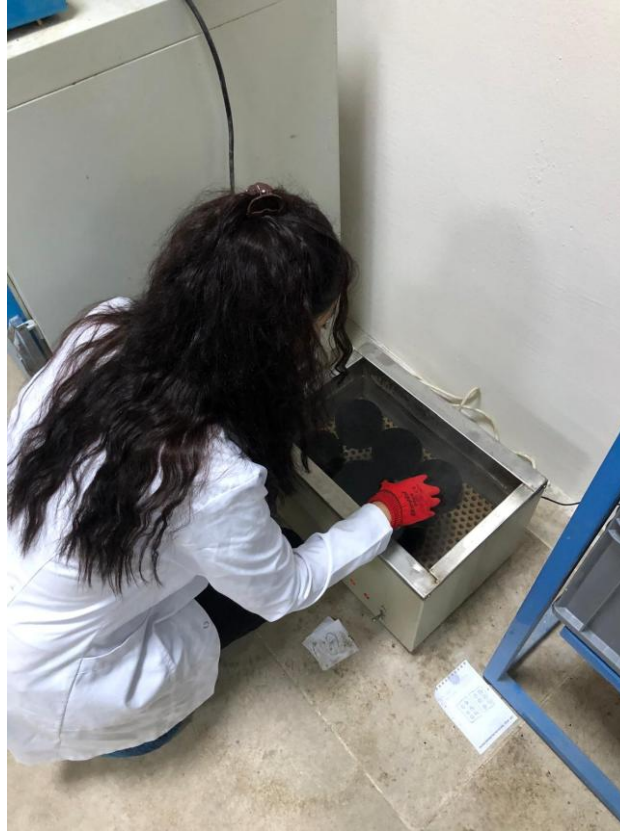
Şekil 3.38. Briketlerin su banyosuna yerleştirilmesi
