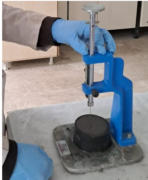
Şekil 3.23. Priz süresi belirleme deneyi
