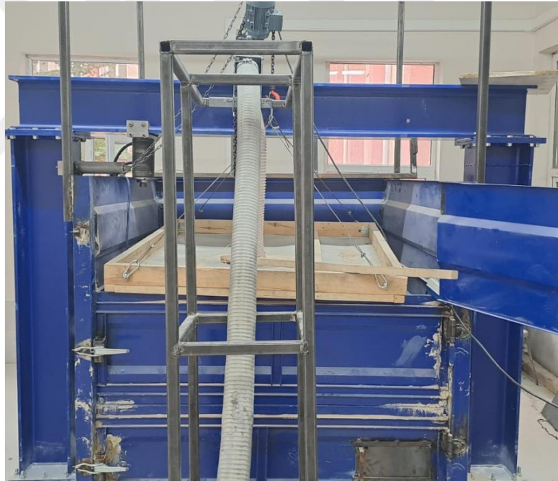
Şekil 3.26. Deney düzeneği, yükleme sistemi ve kum eleği
