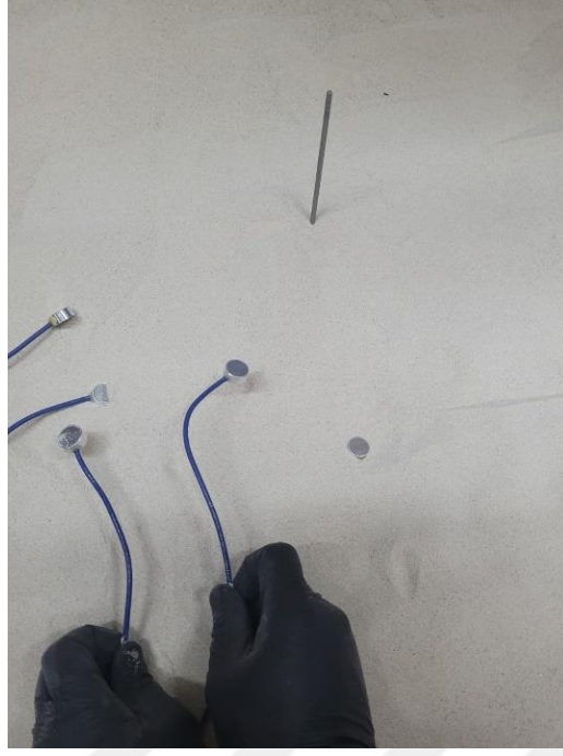
Şekil 3.37. Zemin basınç ölçerlerin yerleştirilmesi
