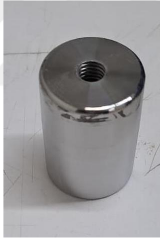
Şekil 3.28. Kazık-mini yük hücresi bağlantısını sağlayan çelik başlık
