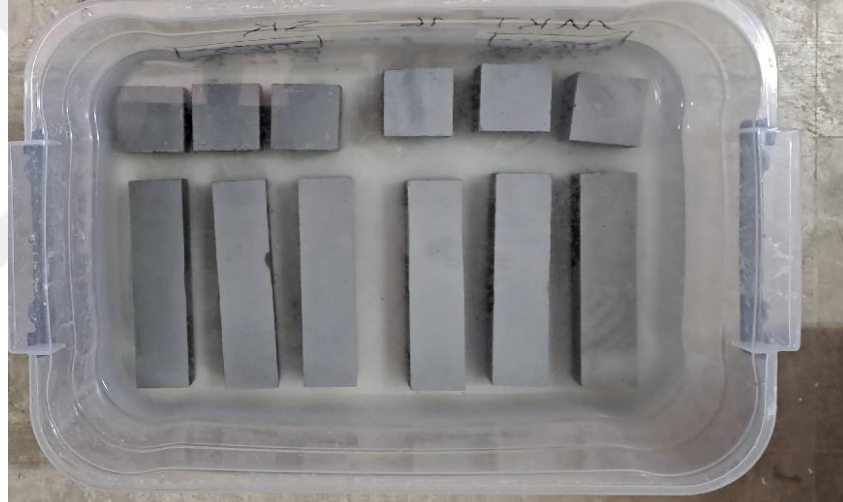
Magnezyum Sülfat Çözeltisinde Bekletilen Numuneler
