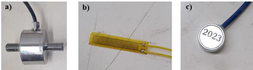
Şekil 3.33. Küçük ölçekli model deneylerde kullanılan ölçüm cihazları: a) Mini yük hücresi, b) Gerinim ölçer pulu, c) Zemin basınç ölçer
