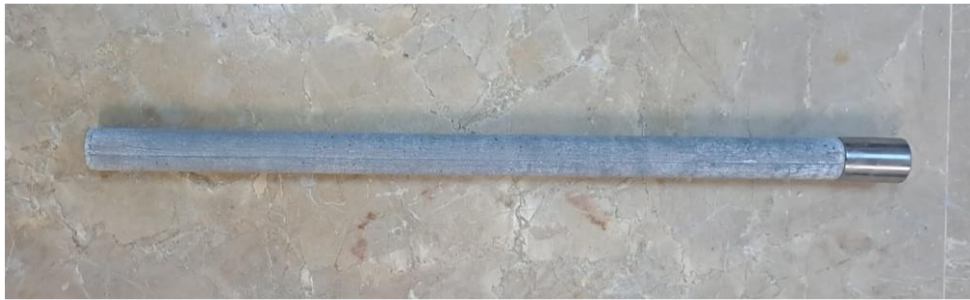
Şekil 3.29. Üretilen GGH kazık
