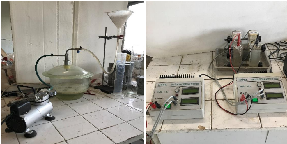
Resim 3.9 Vakum işlemi ve hızlı klorür geçirirnililiği deney düzeneği.
