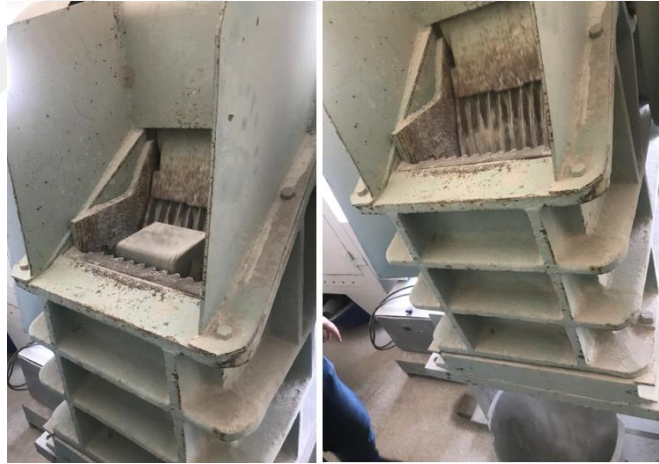
Resim 3.1 Çeneli kırıcı ile agregaya haline getirilen atık beton numuneleri.
