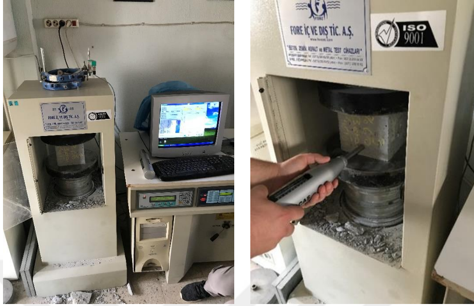
Resim 3.7 Basınç dayanımı deneyinin ve Schmidt yüzey sertliği deneyinin yapılışı.
