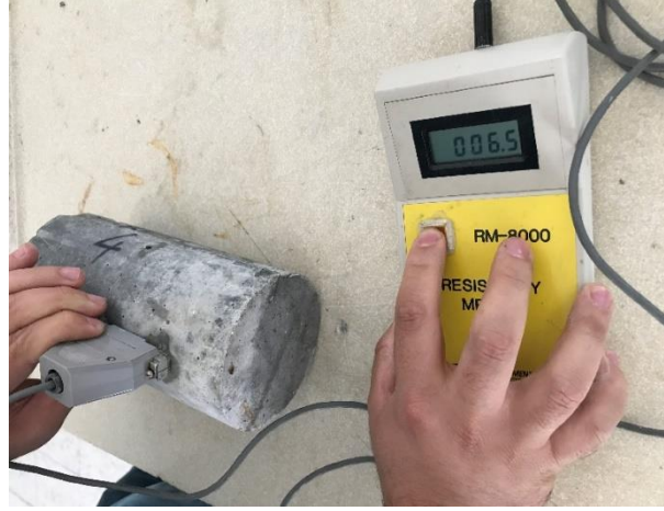
Resim 3.10 Elektriksel özdirenç ölçümü.
