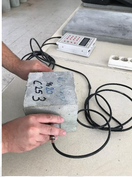
Resim 3.6 Ultrases geiş süresi deneyinin yapılışı.
