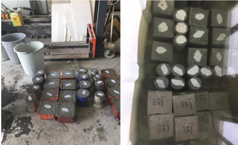
Resim 3.5 Kalıplarda bekletilen ve kür yapılan numuneler.
