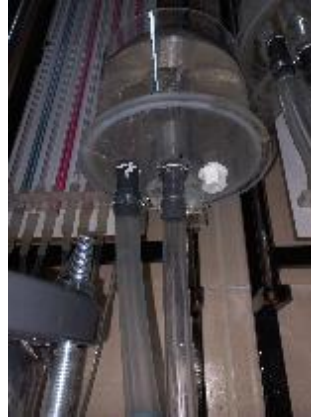
Şekil 26. Pleksiglas sistemden çıkış kabı
