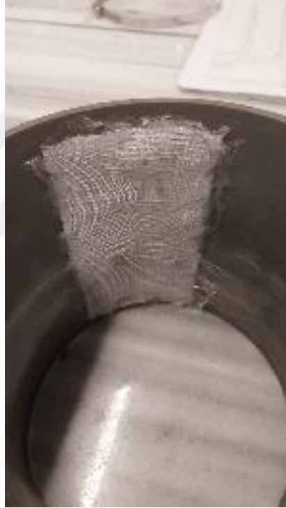
Şekil 15. Manometre girişlerinin örtülmesi
