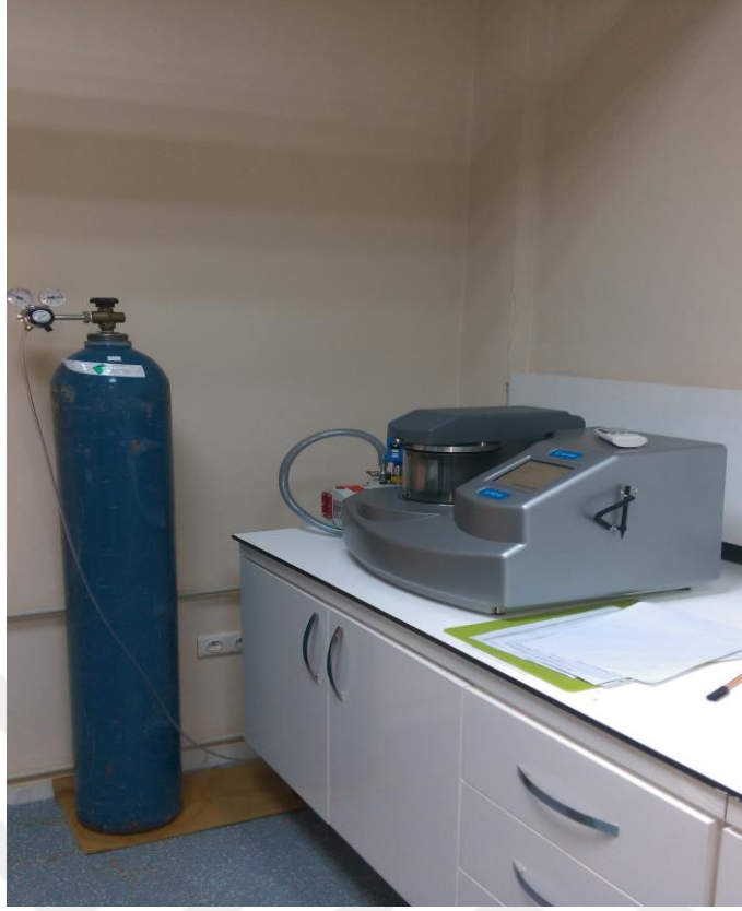
Şekil 3.24: Numune kaplama cihazı.
