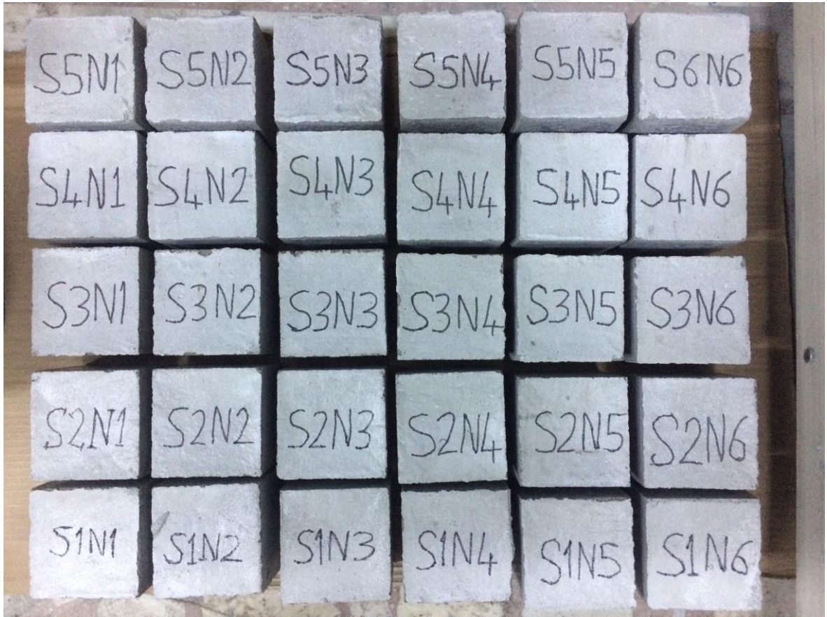
Şekil 3.15: Küp serilerine ait köpük beton numuneleri.
