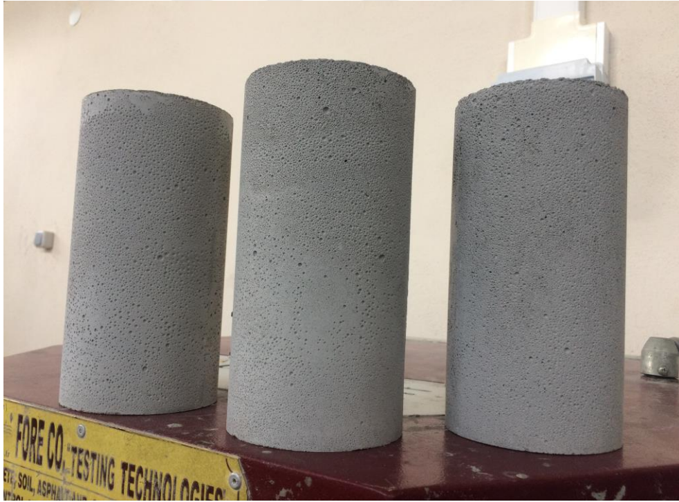
Şekil 3.17: Kalıptan yeni alınmış silindir numuneleri.
