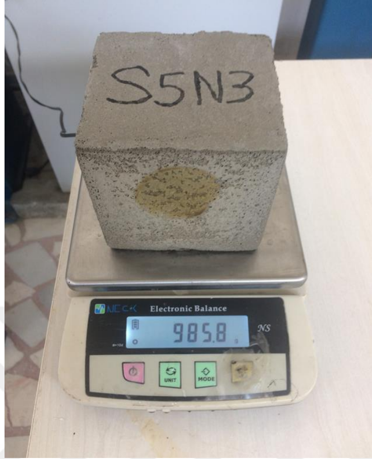
Şekil 3.21: Suya doygun haliyle hassas terazide tartılan numune.
