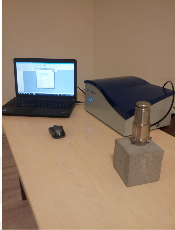
Şekil 3.23: Isıl iletkenlik deneyi.
