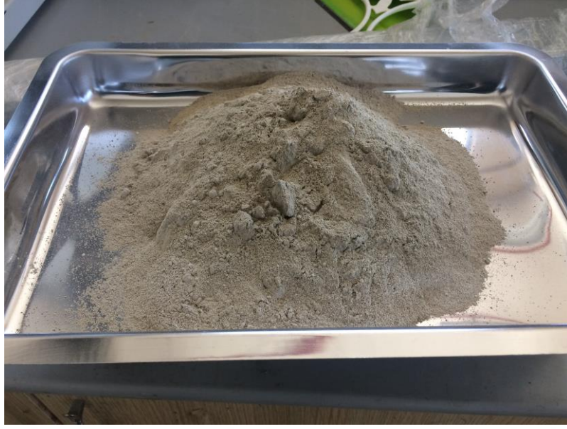
Şekil 3.4: Öğütülmüş beton atığı (ÖBA).
