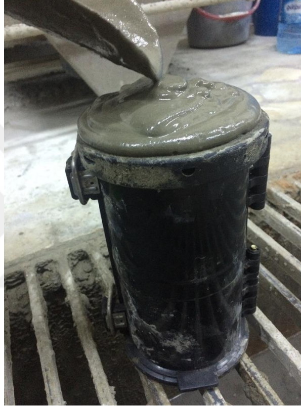
Şekil 3.13: Silindir kalıba yerleştirilen köpük beton harcı.
