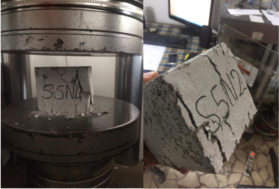
a. S 5 N 4 kırılma şekli.
