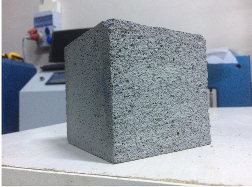
Şekil 3.16: Küp köpük beton numunesi.
