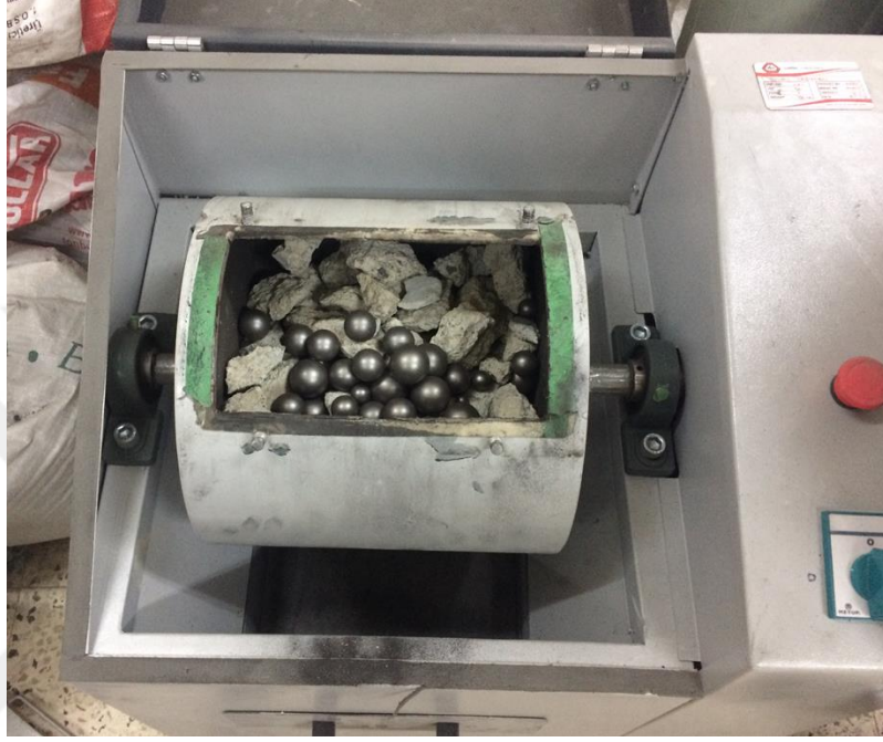
Şekil 3.3: Bilyeli değirmene yerleştirilmiş beton parçaları.
