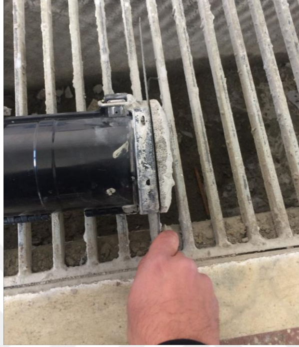
řekil 3.14: Testereyle st yzey fazlalığı kesilen kpk beton.
