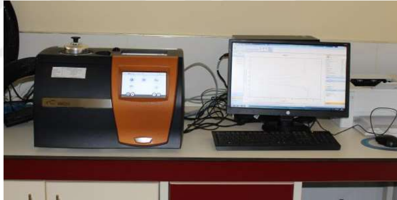
Şekil 3. 6. TA DSC 250 cihazı.
