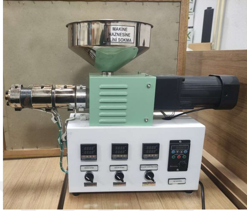
Şekil 3. 3. SJ35 laboratuvar tipi mini tek vidalı ekstrüder.
