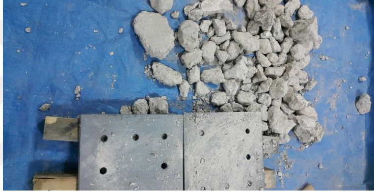
Şekil 3.1 İmar nedeni ile yıkılan binadan temin edilen geri dönüşüm agregalar
