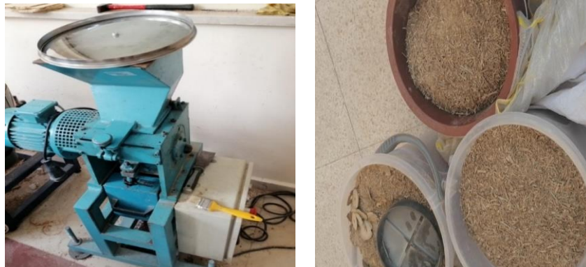
Şekil 3.9. Kesilen bambuların küçük parçalar haline getirilmesi işlemi
