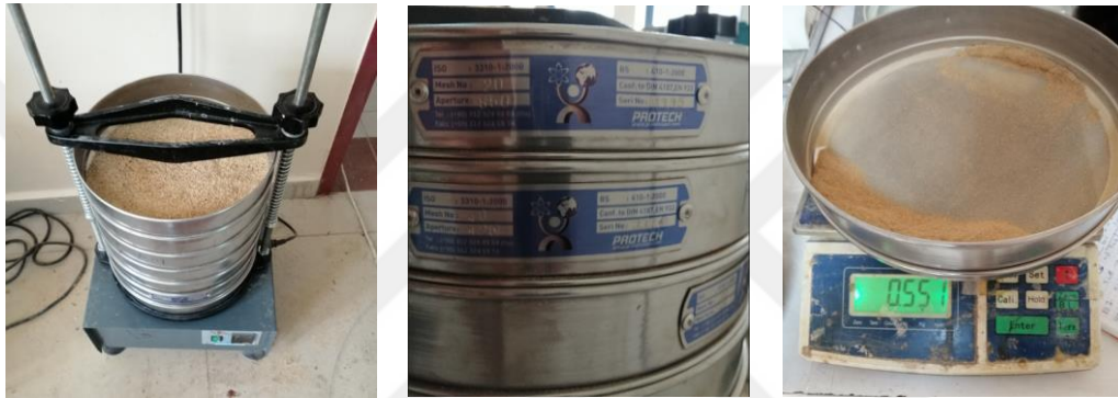
Şekil 3.16. Talaşların çok katmanlı elek ile partikül boyutlarının % miktarının belirlenmesi
