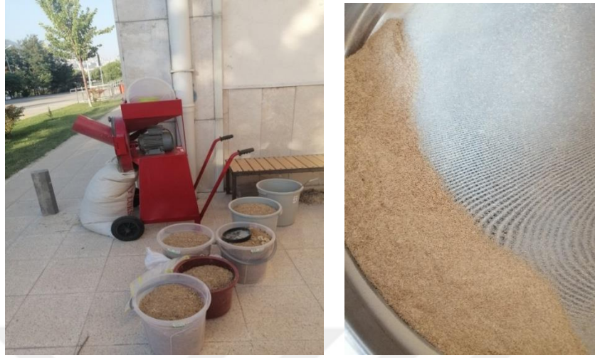
Şekil 3.10. Küçük parçaların talaş haline getirilmesi işlemi
