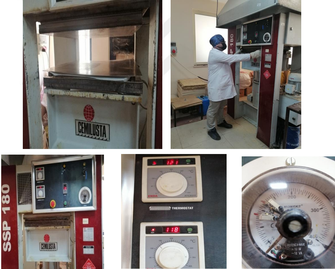
Şekil 3.24. Kalıbın sıcak pres makinasına yerleştirilmesi ve süre, sıcaklık ve basınç ayarı
