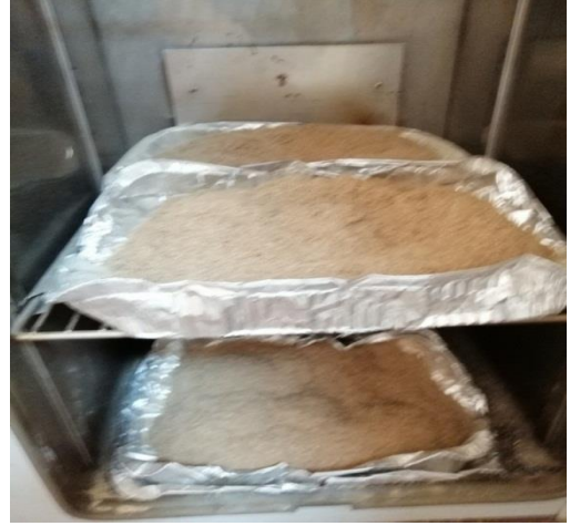
Şekil 3.18. Talaşların etüvde kurutulması işlemi
