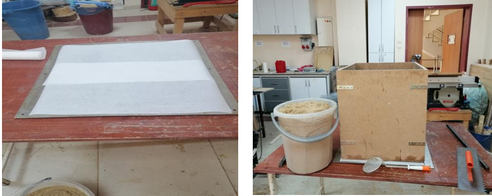
Şekil 3.21. Metal plakaların masaya yerleştirilmesi ve ön presleme işlemine hazırlanması
