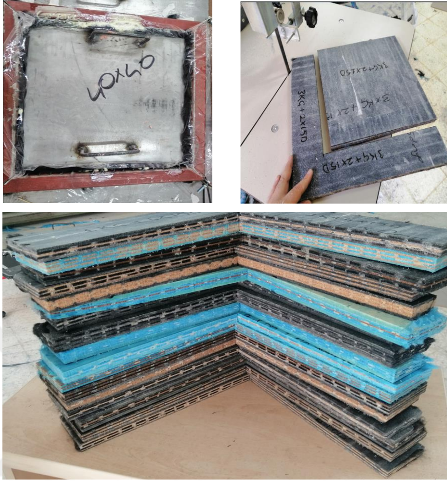
Şekil 3.33. Kompozit malzemenin kalıptan çıkarılması ve kesim işlemi
