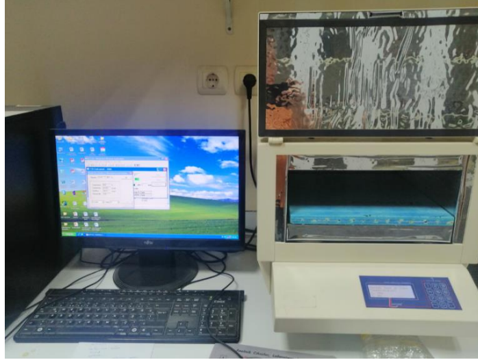
Şekil 3.39. Isıl iletkenlik katsayısı ölçümü
