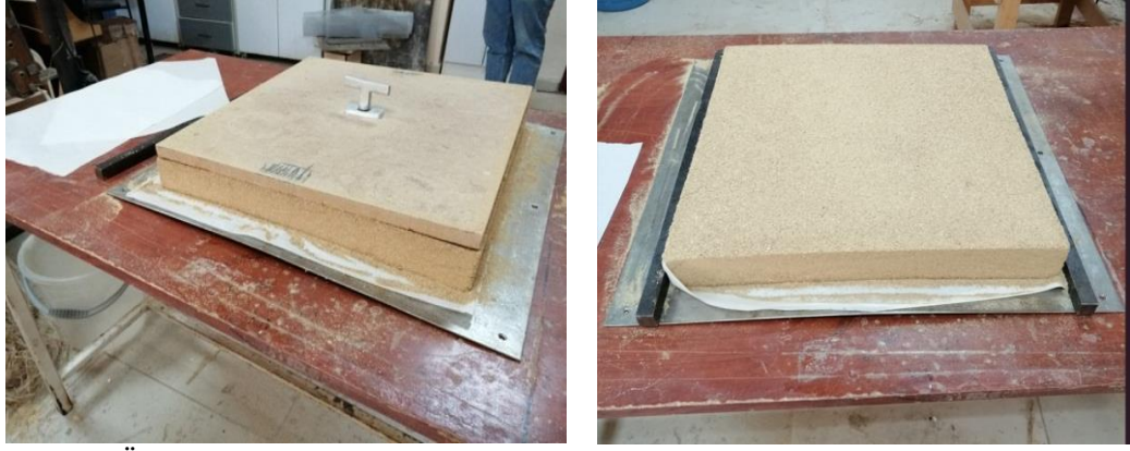
Şekil 3.23. Ön presleme işlemi ve numune kalınlık ayarı için metal çubukların yerleştirilmesi
