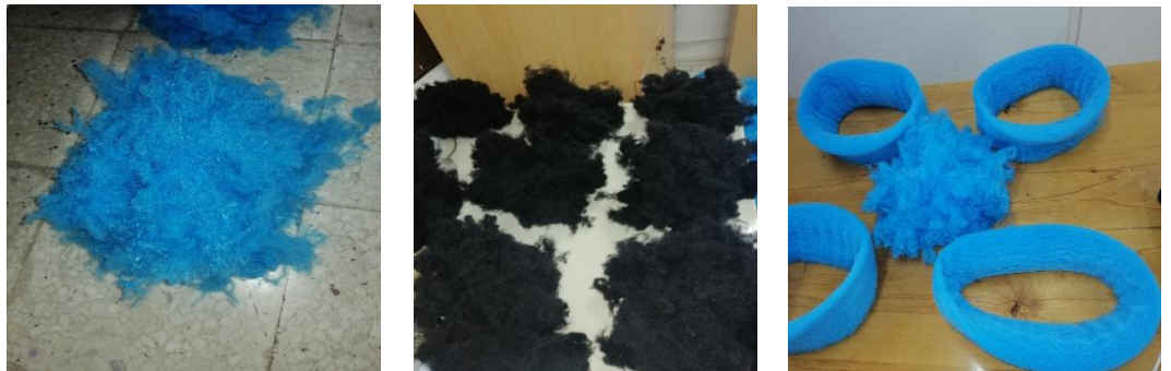
Şekil 3.6. Ön açma işlemi uygulanmış ve paralel hale getirilmiş lifler
