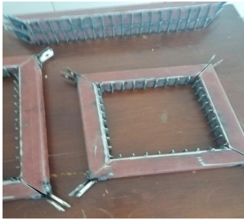
Şekil 3.13. Üretimi tamamlanmış kalıp parçaları
