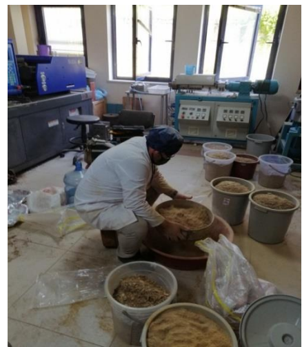
Şekil 3.15 Kızılçam ve bambu talaşının kaba elekten geçirilmesi
