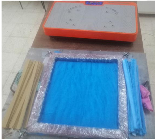
Şekil 3.32. Serim işleminin tamamlanması ve reçinenin kalıba dökülmesi işlemi
