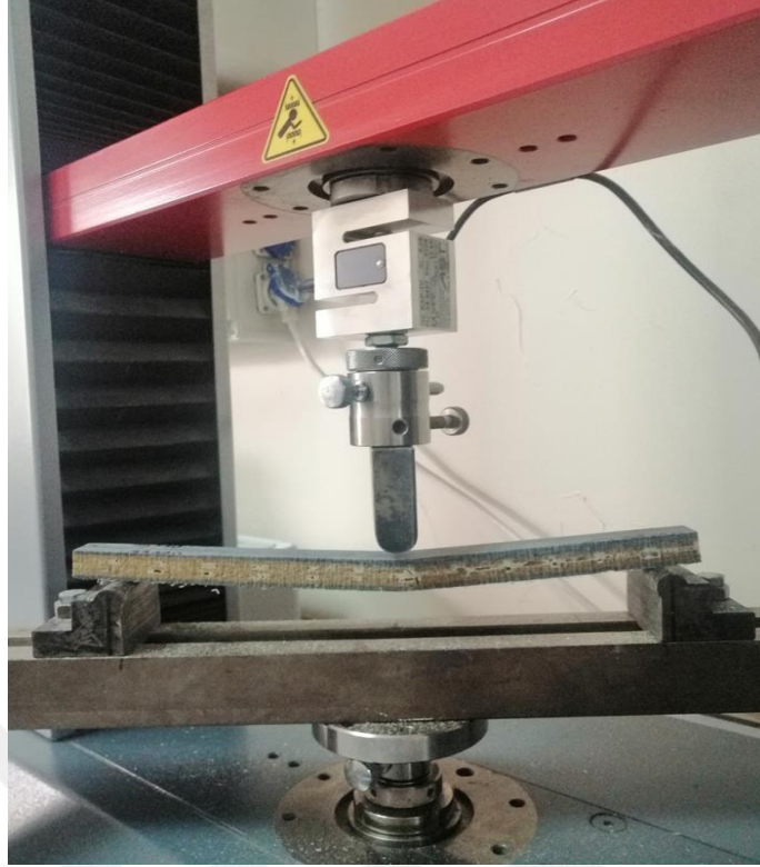
Şekil 3.36. Eğilme dayanımı test cihazı
