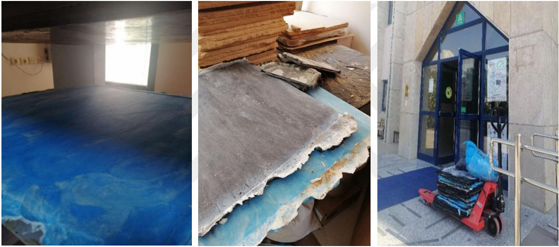
Şekil 3.27. Sıcak pres işlemi sonucu üretilmiş lifli kompozit plakalar
