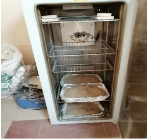
Şekil 3.18. Talaşların etüvde kurutulması işlemi
