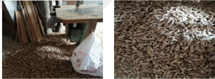
Şekil 3.8. Şerit testere yardımıyla kesilmiş bambular
