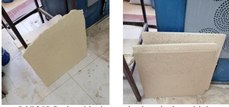
Şekil 3.25. Presleme işlemi sonrası bambu ve kızılçam plakalar
