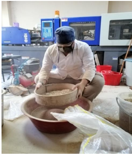
Şekil 3.15 Kızılçam ve bambu talaşının kaba elekten geçirilmesi
