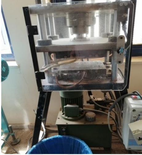
Şekil 3.14. Numune üretim makinası (sıcak pres) ve yapılan deneme üretimleri
