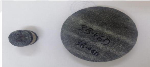
Şekil 3.42. Ses yutum katsayısı ölçümü numuneleri
