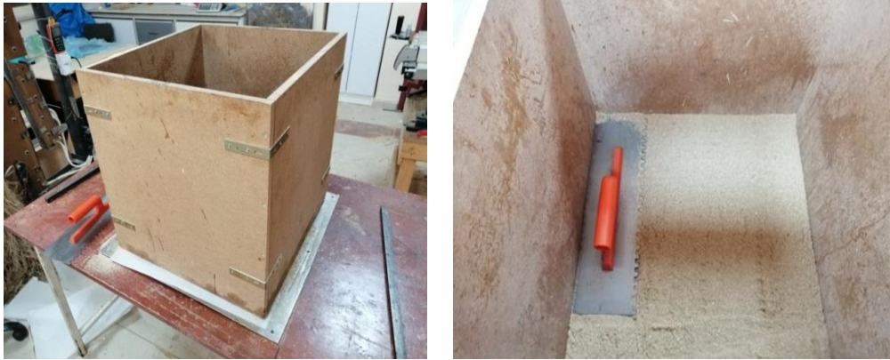
Şekil 3.22. Ön presleme işlemi için reçinelenmiş talaşın serilmesi
