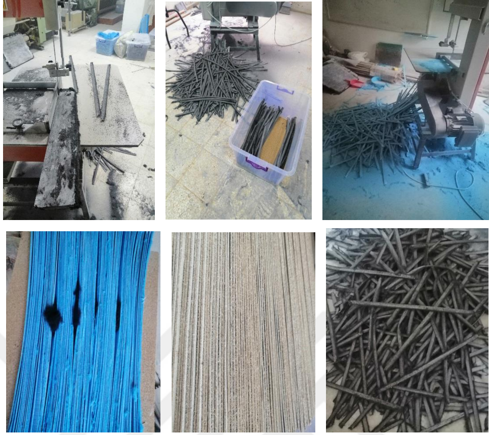
Şekil 3.28. 2 mm kalınlıkta kesilmiş levhalar
