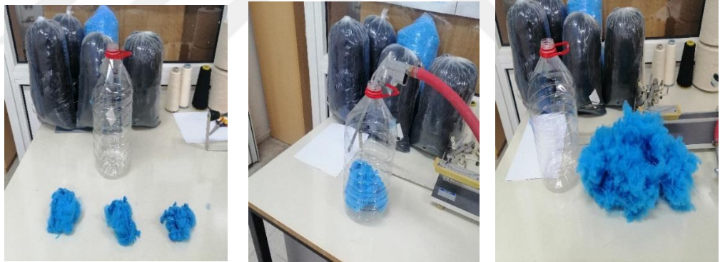
Şekil 3.5. Basınçlı hava ile ön açma işlemi
