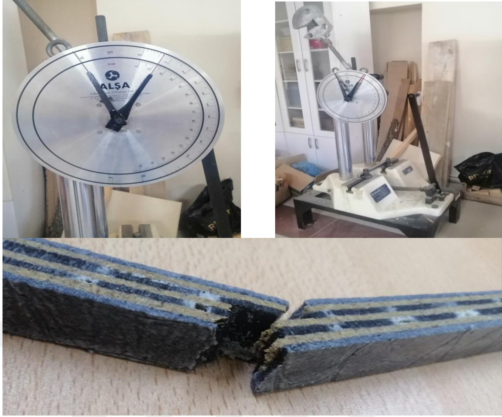
Şekil 3.38. Çarpmaya karşı eğilme mukavemetinin tayini
