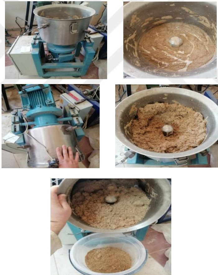
Şekil 3.20. Talaşın karıştırıcıda reçineleneşmesi işlemi
