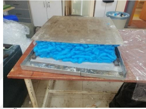
d) Üretim kalıbı içerisine yerleştirilmiş numuneler
