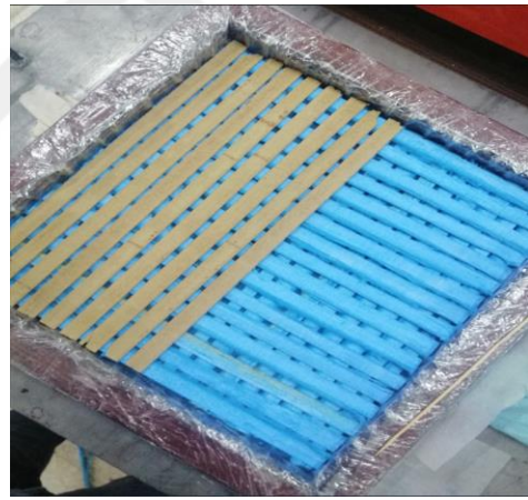
Şekil 3.32. Serim işleminin tamamlanması ve reçinenin kalıba dökülmesi işlemi
