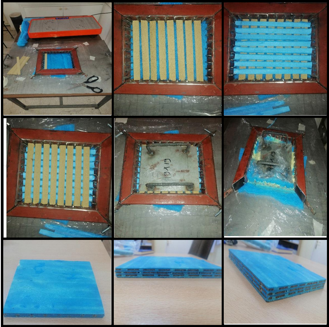
Şekil 3.30. Titreşimli kompozit numune üretim masası ve deneme üretimi
