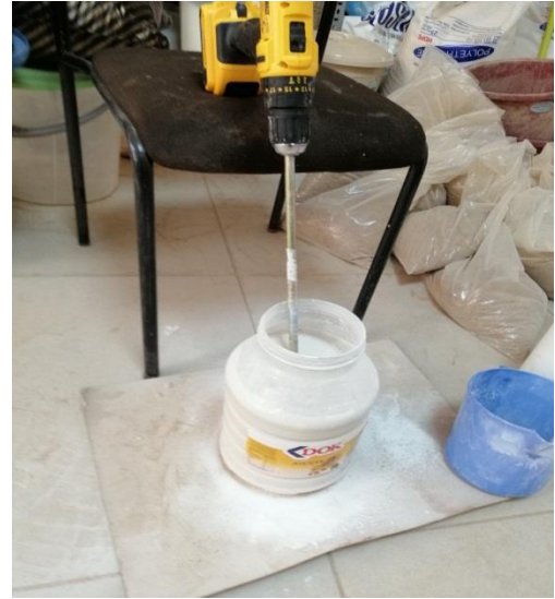
Şekil 3.19. Üre formaldehit reçinesi hazırlama aşaması
