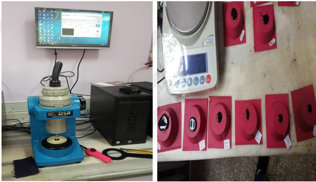
Şekil 2.19. DSR cihazı ve hazırlanan numuneler
