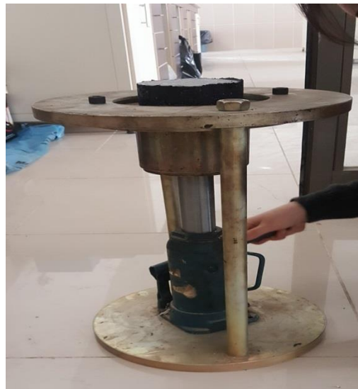
Şekil 4.25. Numunelerin krikoyla çıkarılması
