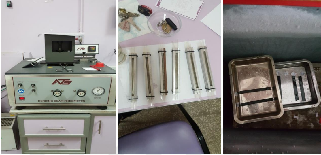
Şekil 2.23. BBR cihazı, kalıplar ve hazırlanan numuneler
